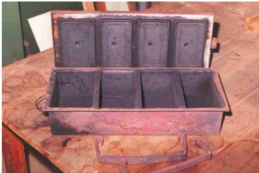
Figura 3. Cadinho metálico utilizado para acondicionar os briquetes durante o tratamento térmico.
