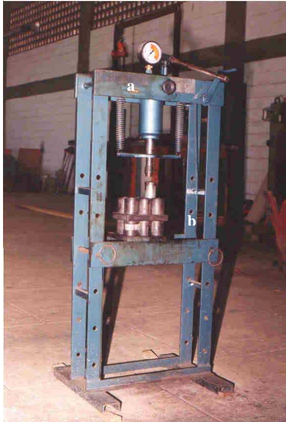
Figura 2. Prensa (a) e fôrma cilíndrica (b), utilizadas na confecção dos briquetes.
