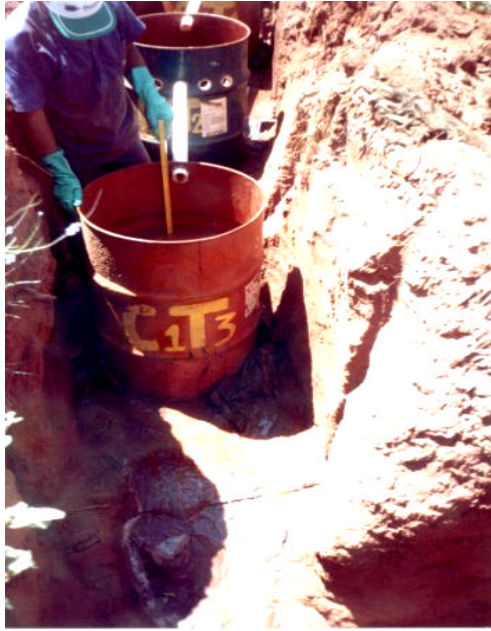
Figura 8 – Medição da altura do nível da água.
