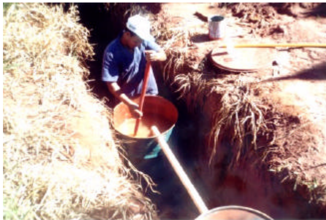
Figura 9 – Homogeneização do material depositado nos tambores coletores.
