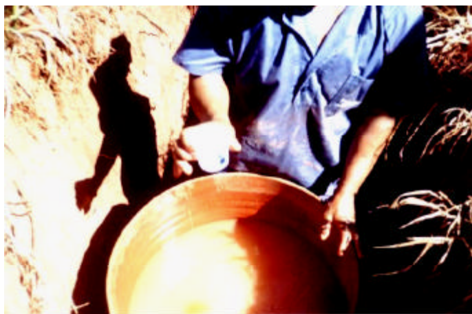
Figura 10 – Retirada da amostra de 100 ml do material homogeneizado.
