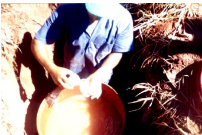
Figura 11 – Amostras de 100 ml reservadas em garrafas plásticas, para posterior determinação do peso do solo.
