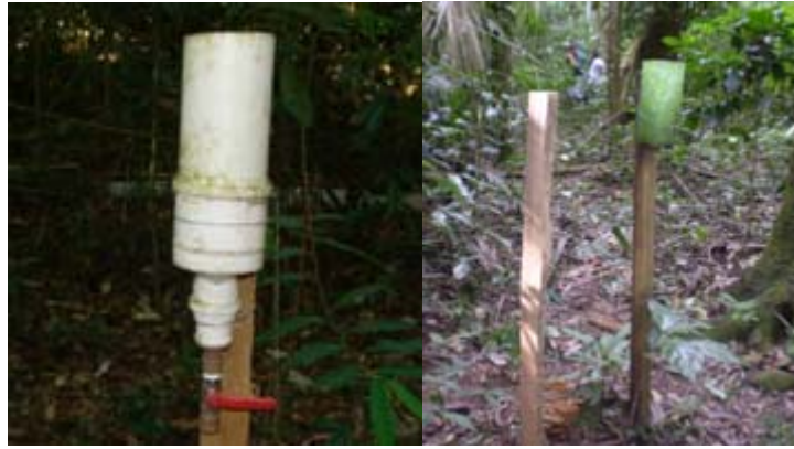
Figura 3 – Pluviômetros utilizados na medição da precipitação interna. Mata do Paraíso, Viçosa-MG, 2009-2011.
