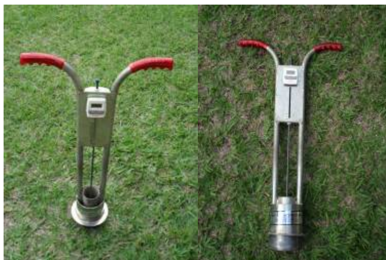
Figura 4 – Infiltrômetro de Anéis modelo Turf Tec, utilizado para mensurar a capacidade de infiltração de água no solo. Mata do Paraíso, Viçosa-MG, 2010-2011.
