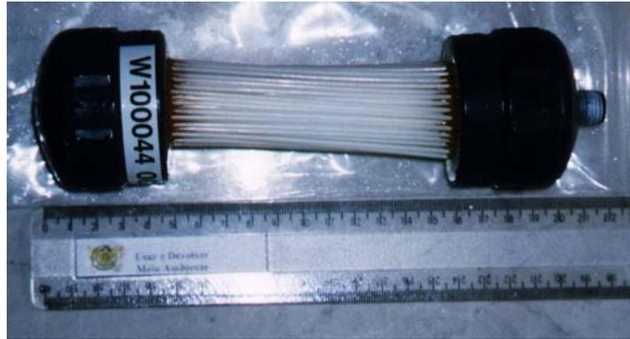
Figura 5.3. Módulo de membrana de ultrafiltração.
