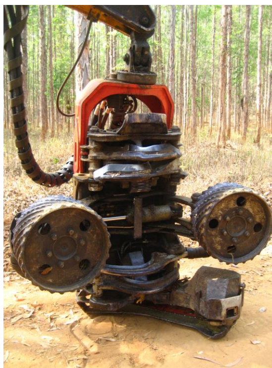
Figura 6 - Cabeçote Valmet 370 E do Harvester usado na pesquisa.
