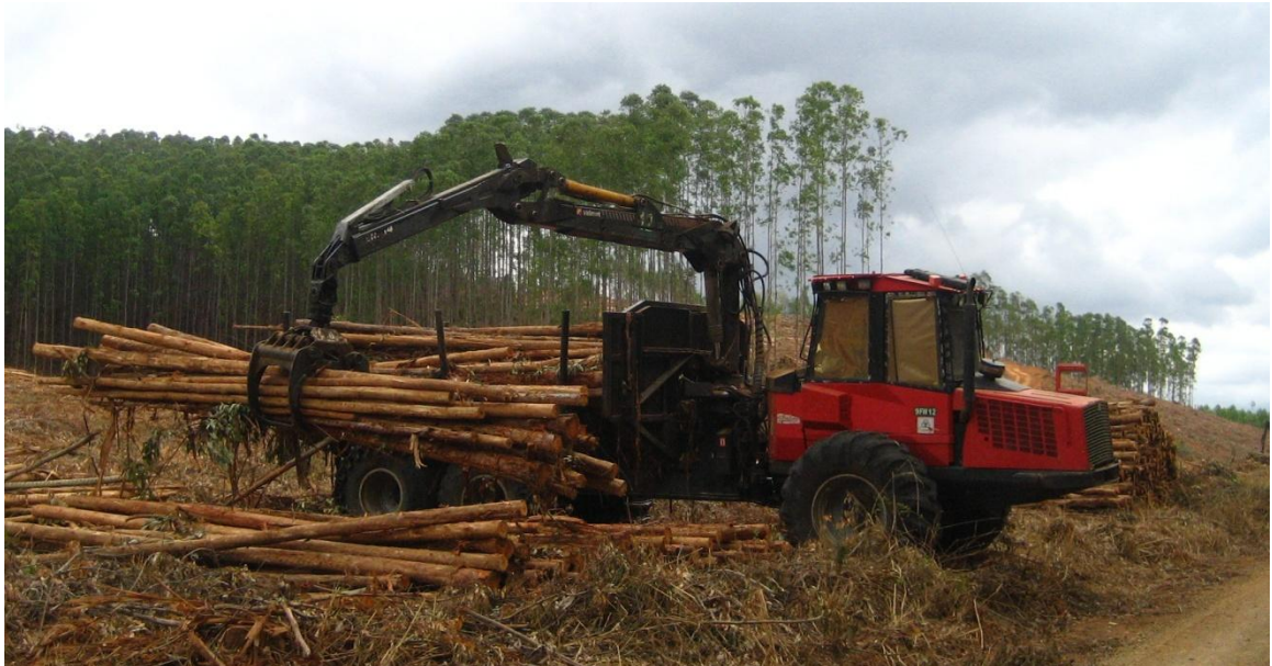
Figura 7 - Forwarder Komatsu Valmet modelo 890.3 usado pelos operadores que participaram da pesquisa.
