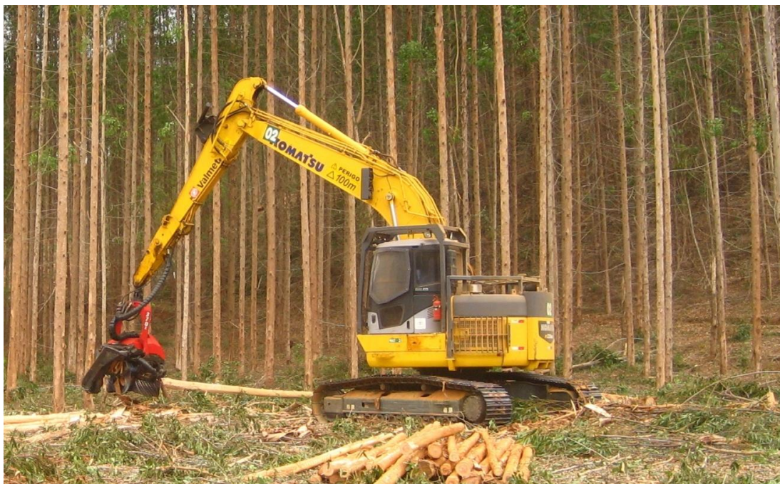
Figura 5 - Modelo do Harvester Komatsu Valmet PC 228 USCC usado na pesquisa.
