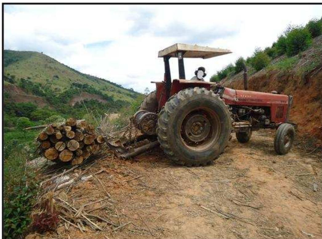
Figura 8 - Extração de madeira por meio de guincho TMO
