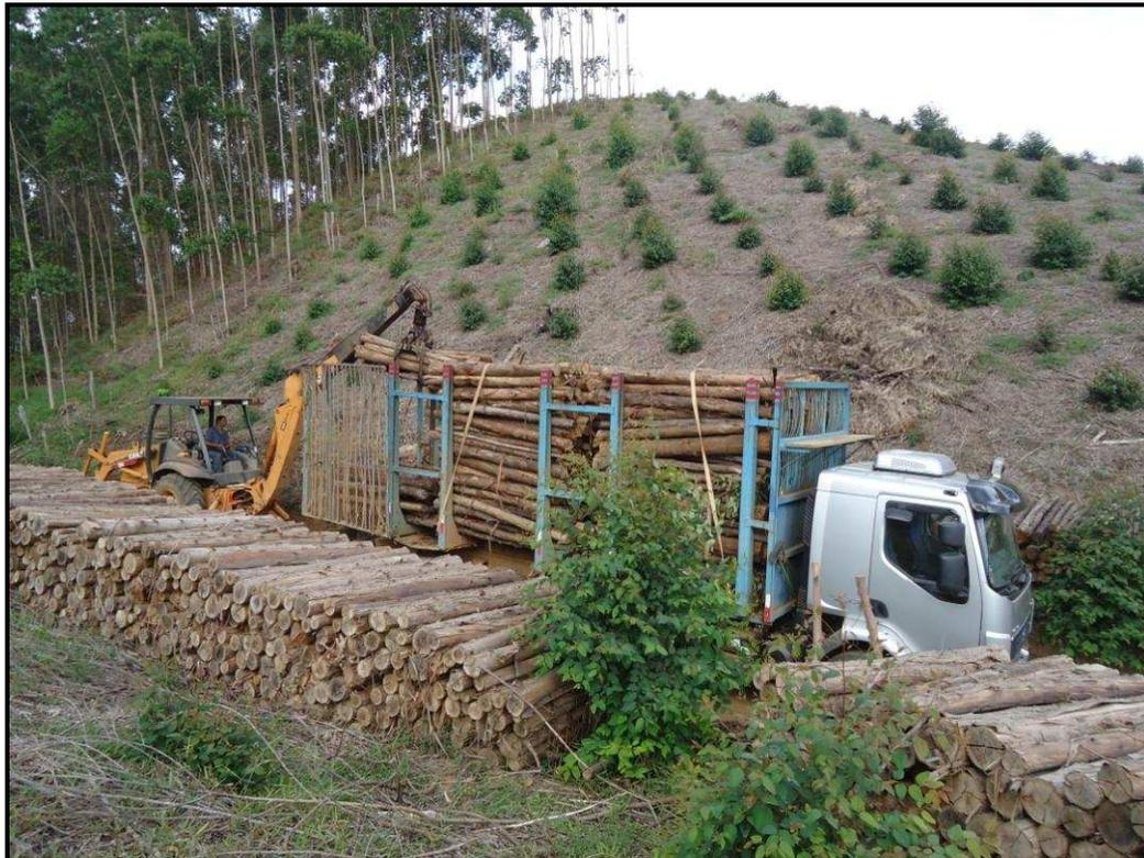
Figura 10 - Carregamento do caminhão transportador com máquina agrícola adaptada
