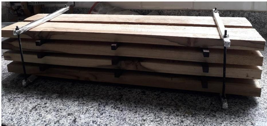
A termorreificação foi realizada à temperatura de 160° C, com tempo de duração de 3 horas. As madeiras foram inseridas na estufa somente após atingir a temperatura desejada, a câmara foi evacuada e posteriormente preenchida com gás nitrogênio até uma pressão máxima
