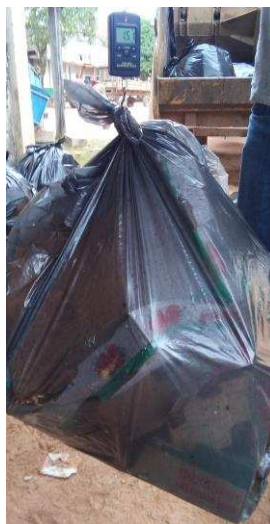
Figura 5 - Balança do tipo suspensa utilizada para a pesagem dos resíduos sólidos durante a 87ª Semana do Fazendeiro (17 a 23 de julho de 2016), Campus da Universidade Federal de Viçosa, Viçosa, Minas Gerais.
