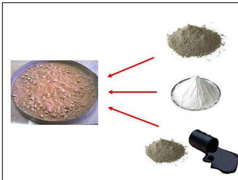
Figura 9. Adição de cimento, cal e cimento-emulsão, respectivamente e em ensaios separados, ao solo de interesse.
