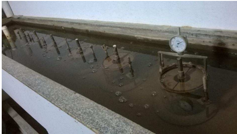
Figura 12. Corpos de prova em imersão no ensaio CBR.
