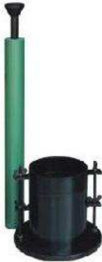
Figura 11. Soquete e cilindro Califórnia; equipamentos utilizados no ensaio de compactação.
