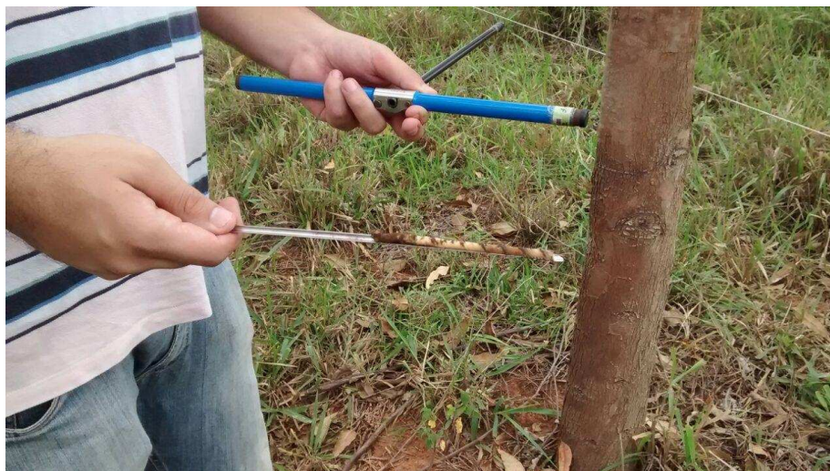
Figura 1: Amostras retiradas com auxílio de um trado manual, para calcular a densidade básica da madeira do componente arbóreo do sistema silvipastoril.
