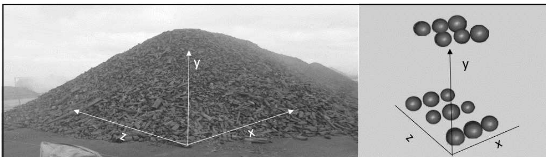
Figura 4 - Esquema ilustrativo de unidades amostrais no estoque do forno RAC 220.
