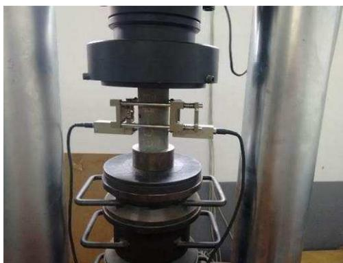
Figura 18. Ensaio de módulo de elasticidade com clip gage.
