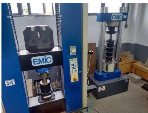
Figura 17. Máquina universal de ensaios da marca EMIC, modelo DL600KN.
