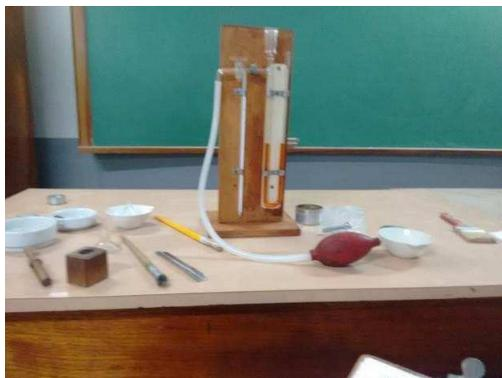
Figura 10. Materiais para o ensaio de área de permeabilidade de Blaine.
