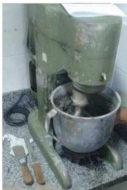
Figura 15. Argamassadeira, misturador mecânico.
