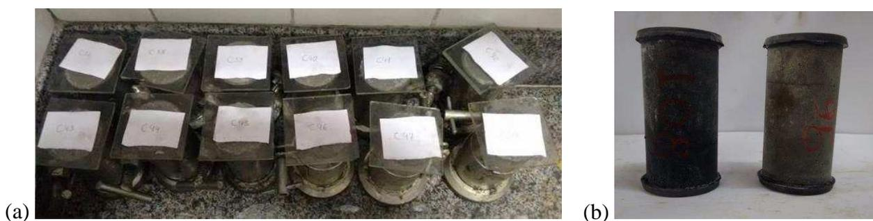
Figura 16. Corpos de provas (a) Moldados e (b) Desmoldados e devidamente identificados.
