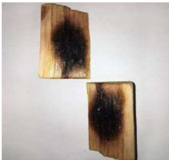
Figura 3. Amostras de madeira submetidas à potência de micro-ondas e tempo de exposição inadequados.
