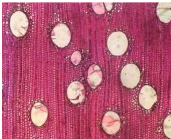
Figura 15. Corte transversal evidenciando a presença de tiloses obstruindo os vasos da madeira de Eucalyptus sp. utilizada no estudo. Aumento 10x.
