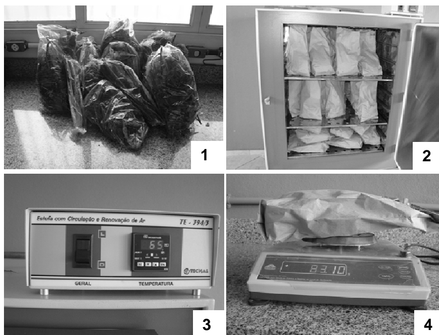
Figura 2 – (2.1) Amostras úmidas; (2.2) Amostras levadas para o laboratório e colocadas na estufa. (2.3) Temperatura de secagem das amostras; (2.4)- Determinação da massa de matéria seca das amostras (Ms (a)), em kg.
