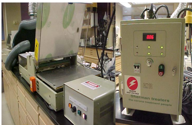
Figura 3 – Equipamento gerador de plasma atmosférico, através de descarga por barreira dielétrica.
