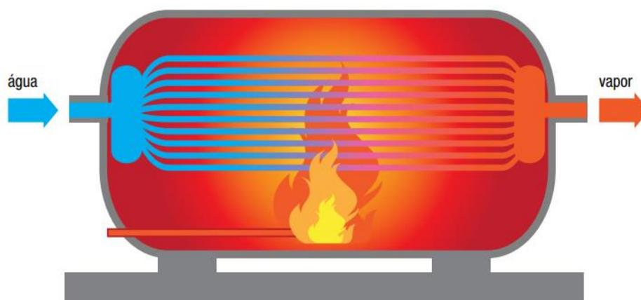
Figura 8: Representação esquemática de caldeira aquatubular.
