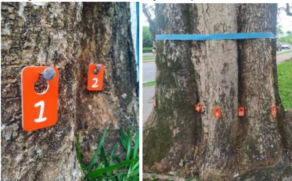
Figura 8 – MPs alocados na árvore para inserção dos eletrodos e sensores.
