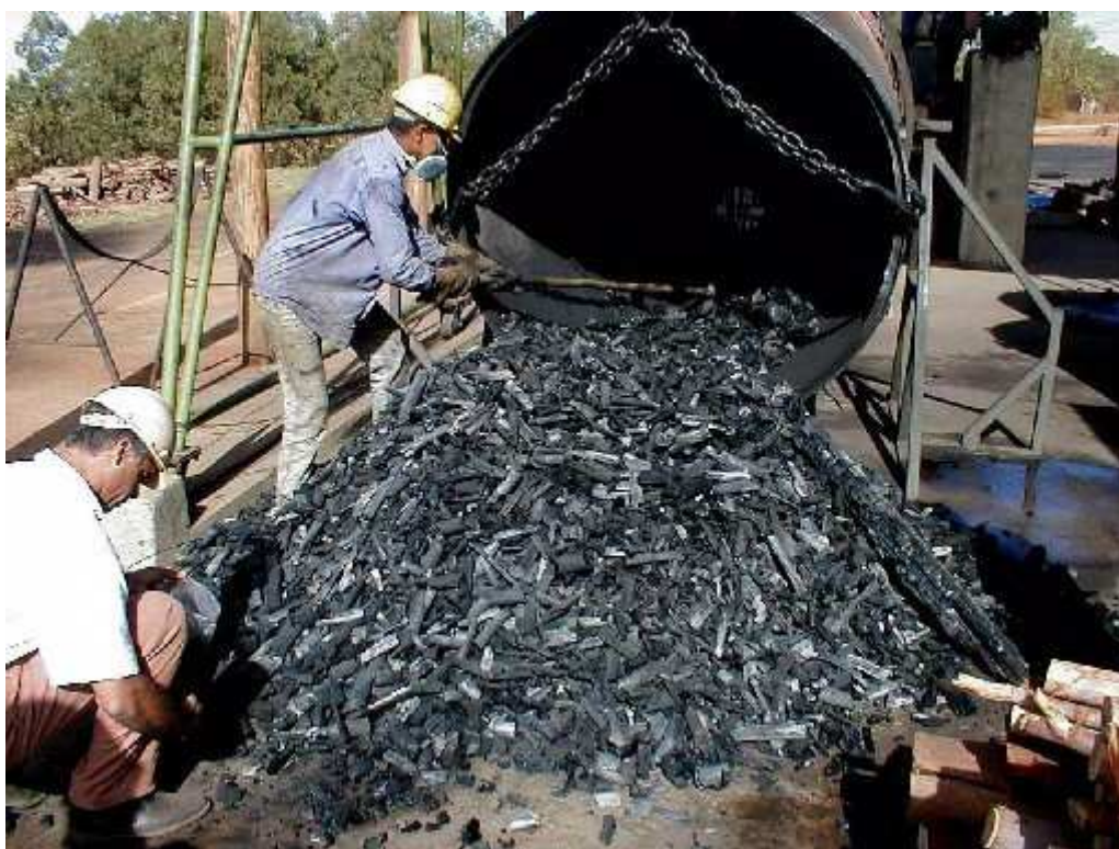
Figura 3 -Descarga do carvão do forno container (instalado na V & M do Brasil, localizado na cidade de Paraopeba)
