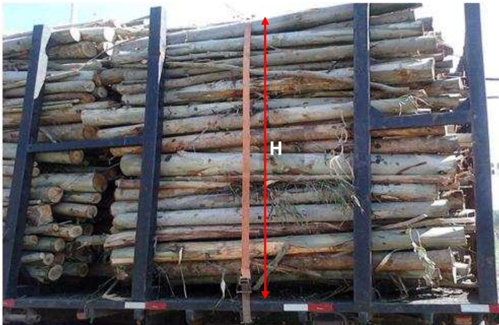
Figura 2 – Medida da altura de madeira no caminhão, sendo H a altura medida, em metros. Pilha meramente ilustrativa do processo, não amostrada.
