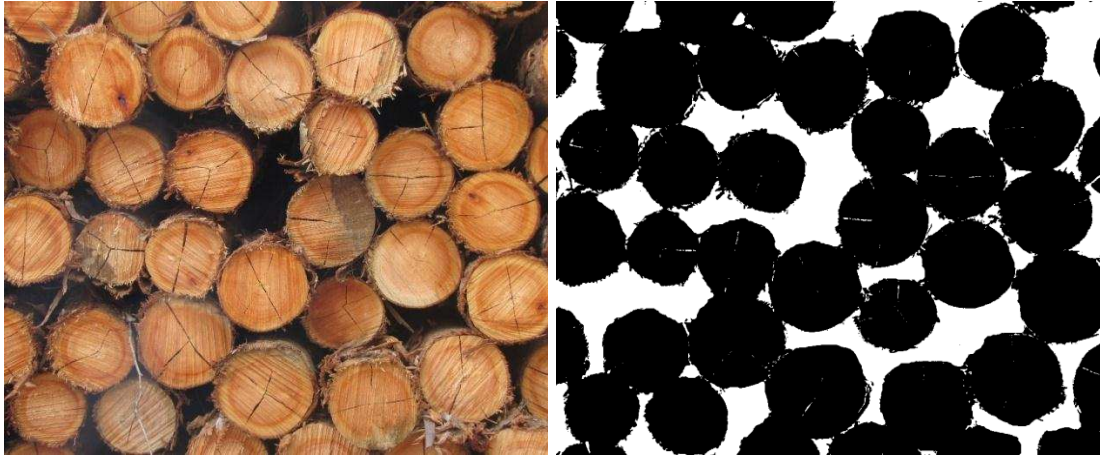
Figura 16 - Imagem digital de pilha de madeira para estimação do fator de empilhamento e resultado da classificação.
