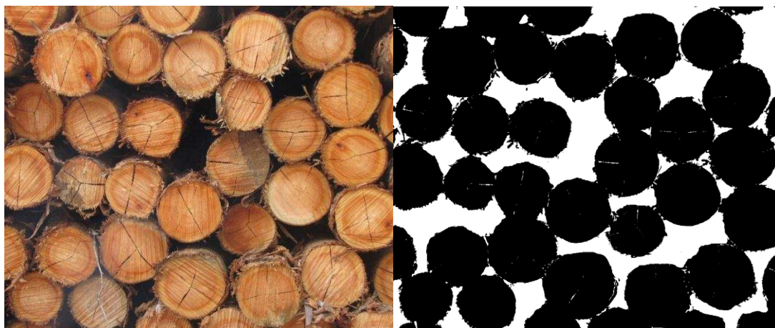
Figura 4 – Foto original da pilha, à esquerda, e imagem após aplicação da RNA, à direita.
