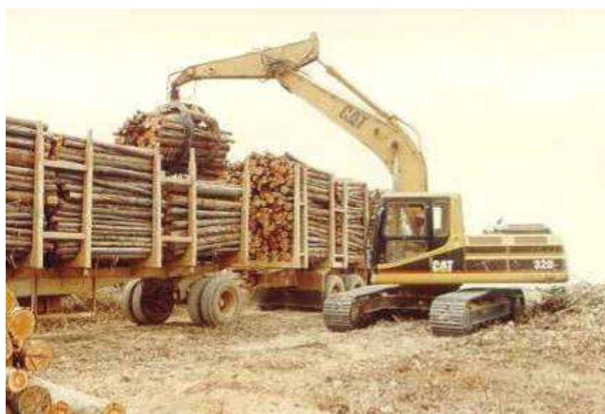
Figura 8 - Carregador florestal montado em máquina-base de esteira.
