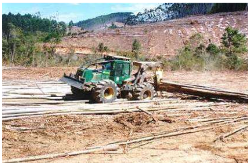
Figura 5 - “Skidder” com garra executando o arraste de toras.
