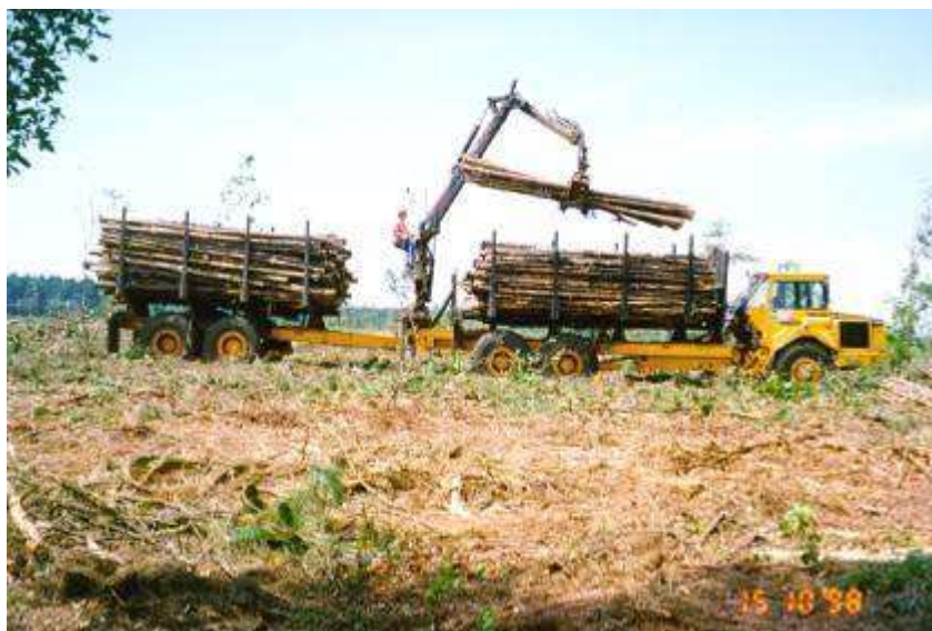
Figura 7 - “Timber hauler” executando a extração de madeira.
