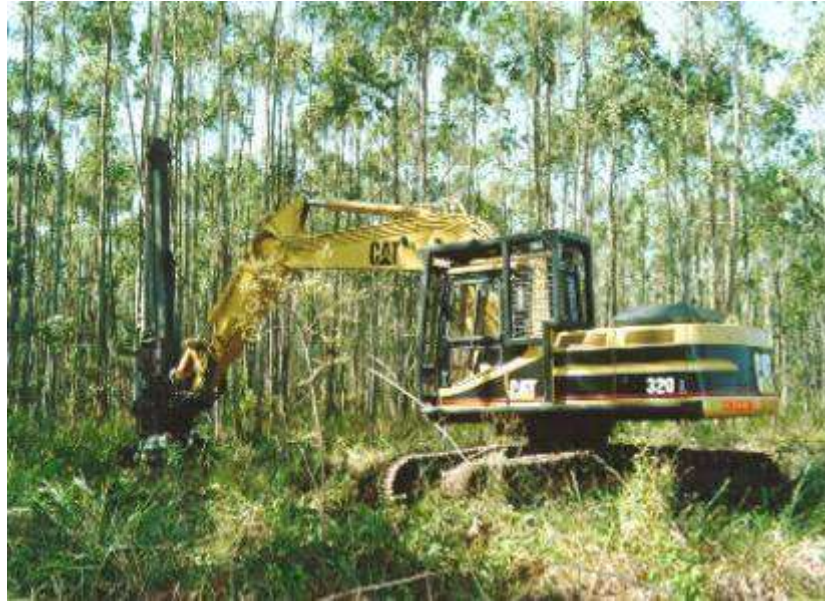
Figura 3 - "Slingshot" executando a derrubada de árvores.
