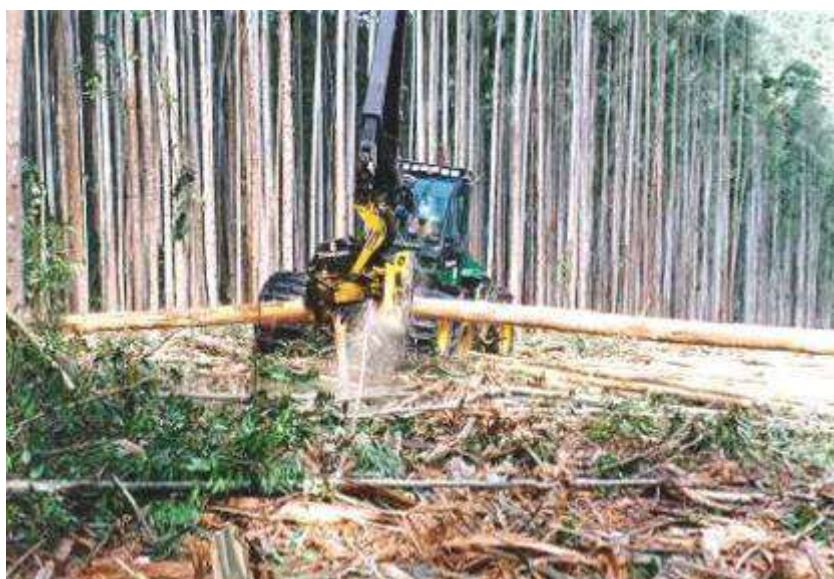
Figura 1 - “Harvester” executando o processamento de árvores.
