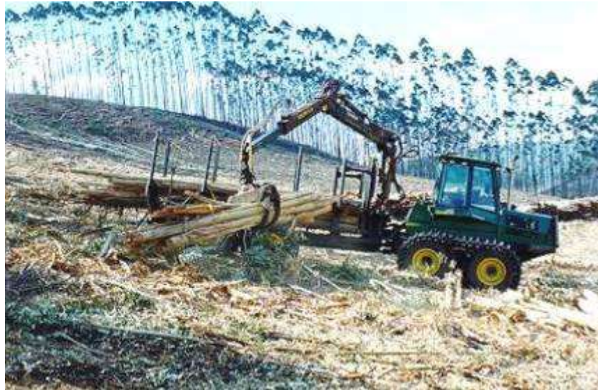
Figura 4 - "Forwarder" executando a extração de madeira.
