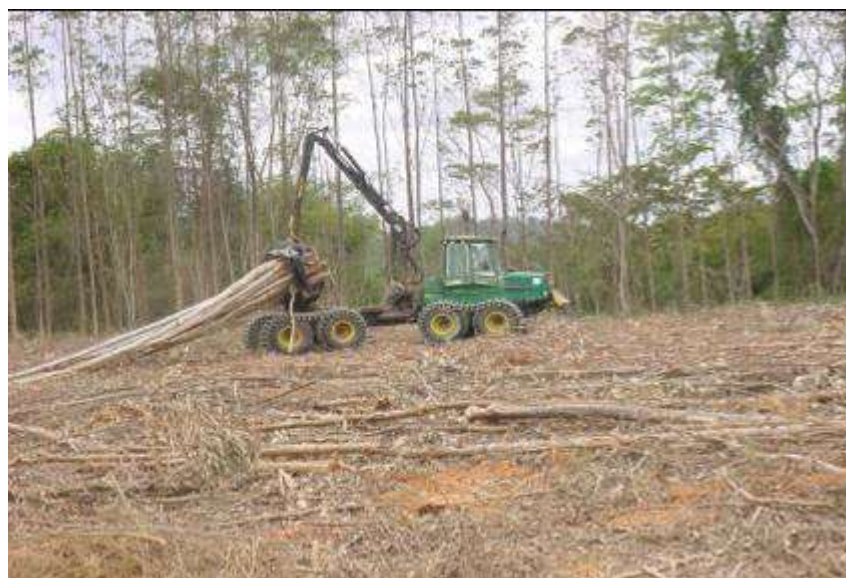
Figura 6 - “Clambunk skidder” executando o arraste de toras.
