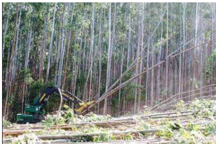
Figura 2 - “Feller-buncher” executando a derrubada de árvores.
