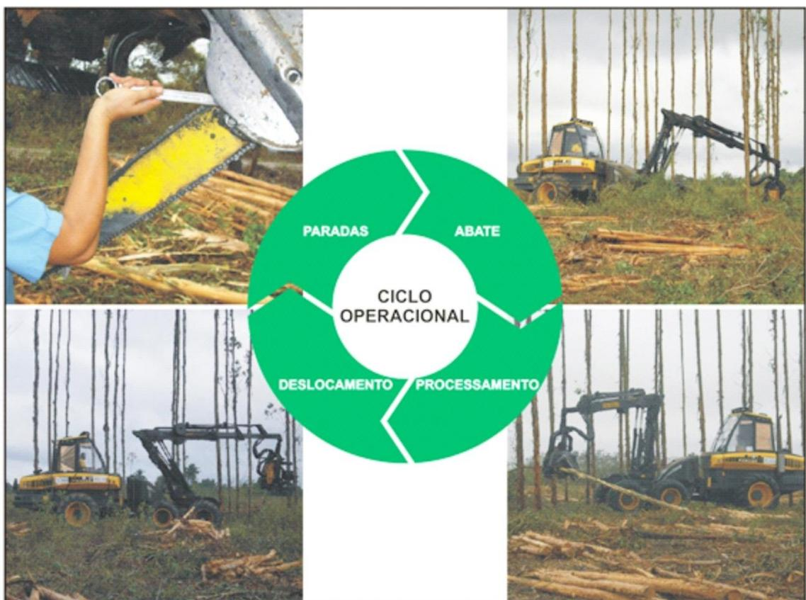
**Figura 5** – Ilustração do ciclo operacional do *harvester*.
