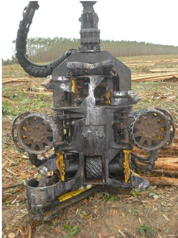
**Figura 3** – Cabeçote Ponsse, modelo H8, utilizado no corte e processamento de eucalipto.
