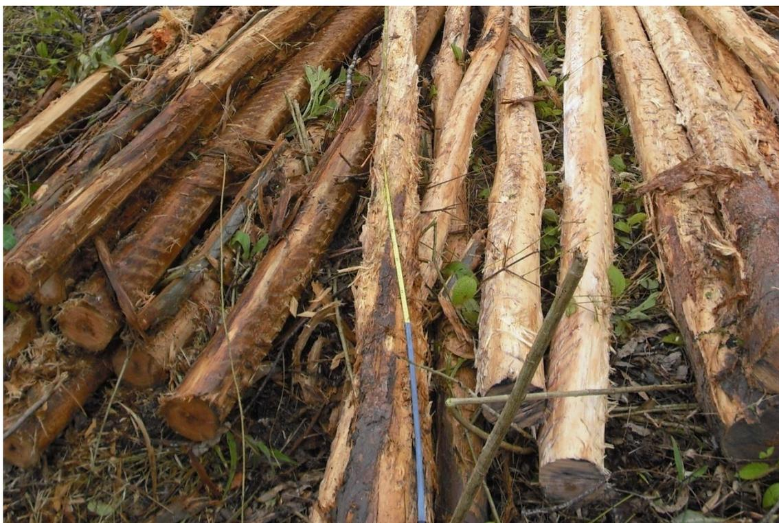
**Figura 7** – Feixe de toras recém processadas e com partes de cascas, evidenciando a dificuldade de se descascar a madeira.
