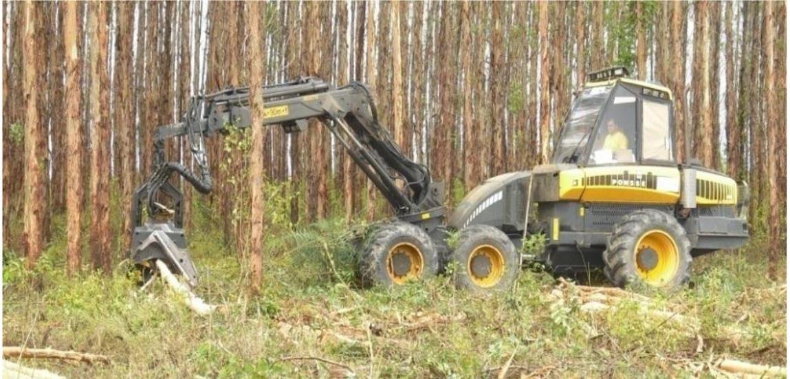
**Figura 2** – *Harvester* da marca Ponsse, modelo C33, operando no corte e processamento de eucalipto.
