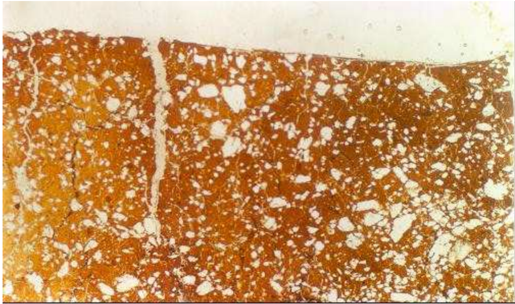
Figura 6A – Mosaico de fotomicrografias sob lupa binocular, com aumento de 10 vezes, a 1cm de distância do contato solo-raiz, em amostras compactadas por raízes 8,0 cm de diâmetro. Dimensão: 23,09 x 13,53 cm 78 Pixel/cm
