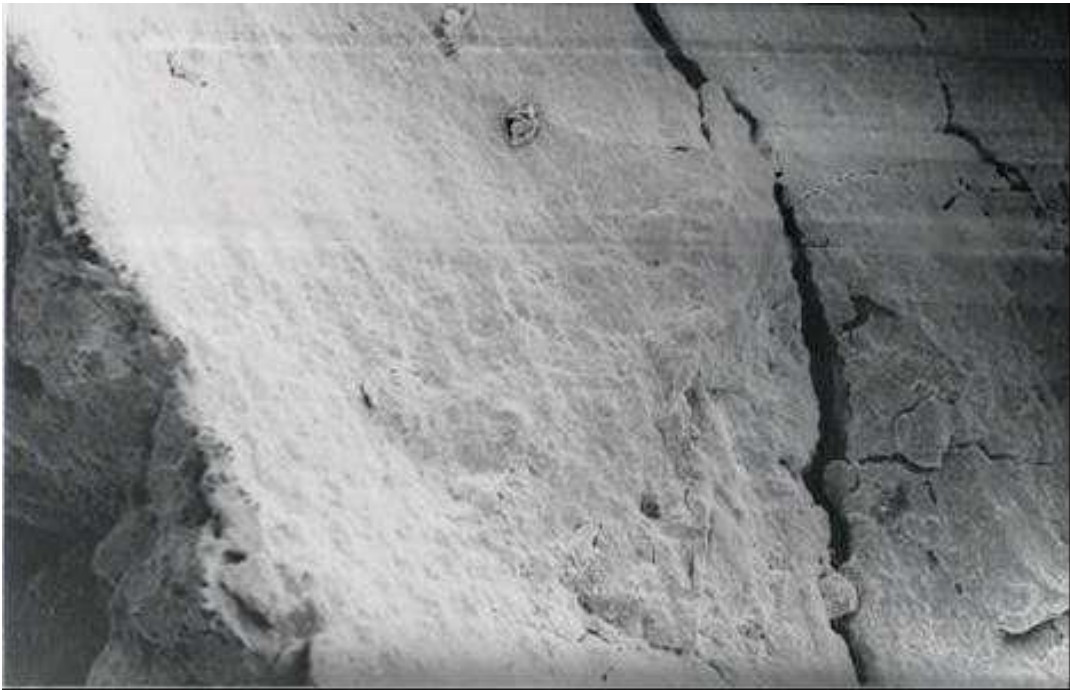
Figura 10A - Fotografia em microscópio eletrônico de varredura com aumento de 200 vezes, superfície lustrosa da área da raiz, sem raízes, com adensamento e presença de trincas (fraturas).
