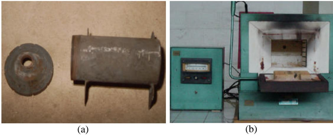
FIGURA 10 – a) Cadinho utilizado para carbonizar as amostras e b) mufla de laboratório.
