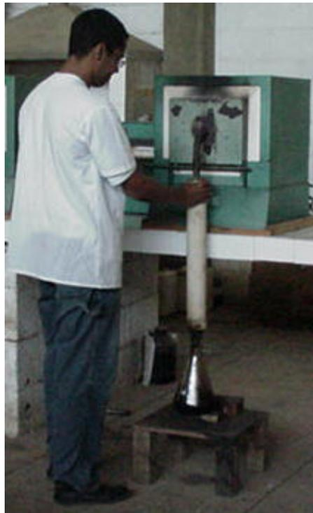
FIGURA 11 – Equipamento utilizado para carbonização, com sistema coletor de líquido pirolenhoso.
