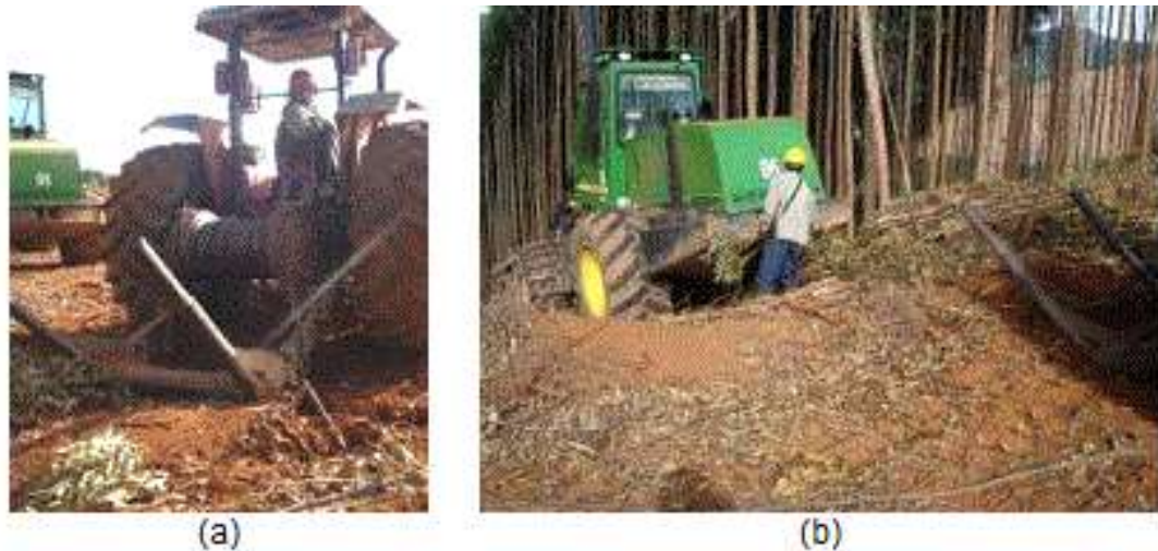
Figura 10 – Trator agrícola Massey Ferguson 297 acionando o guincho da marca TMO (a) e em engate do cabo de aço para auxiliar no deslocamento do harvester (b).
