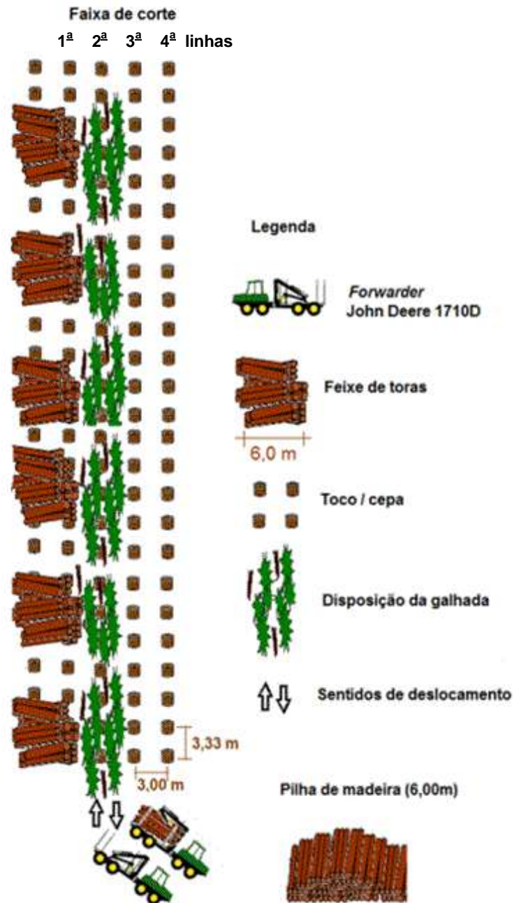
Figura 8 – Sequência operacional do forwarder em cada unidade experimental.
