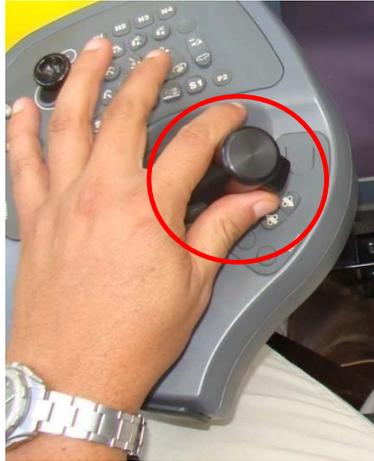
Figura 20 – Aspecto visual do movimento de pinça pulpar no *joystick* do harvester
