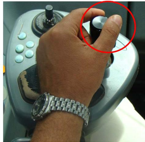
Figura 19 – Aspecto visual do movimento de pinça pulpar no *joystick* do forwarder
