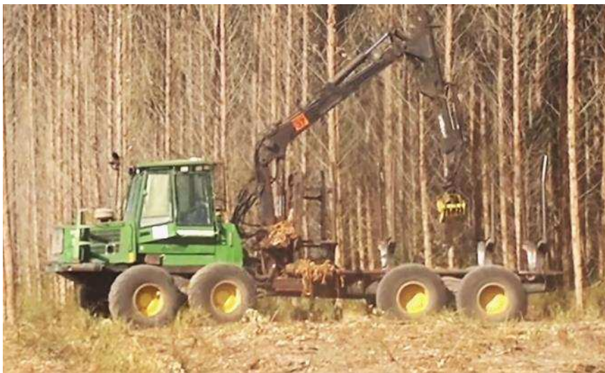
Figura 6 – Forwarder utilizado na extração de madeira, modelo John Deere 1710
