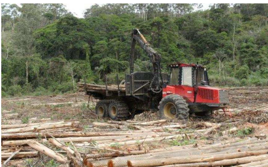
Figura 5 – Forwarder utilizado na extração de madeira, modelo Komatsu Forest 860.3
