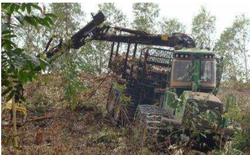
Figura 7 - Forwarder utilizado na extração de madeira, modelo John Deere 1910
