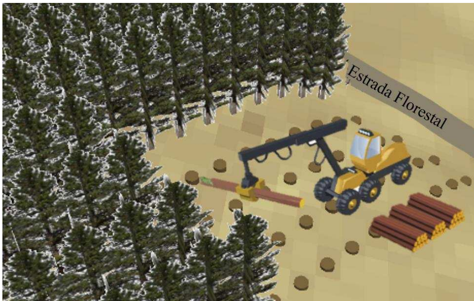
Figura 3 - Esquema da operação do corte florestal com harvester
