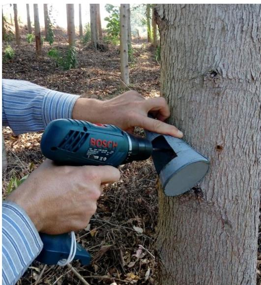
**Figura 10.** Coleta de serragem para determinação do teor de umidade.
