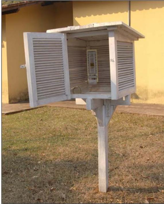
Mini-estação meteorológica: termômetro e higrômetro
