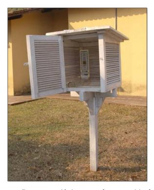
Mini-estação meteorológica: termômetro e higrômetro
