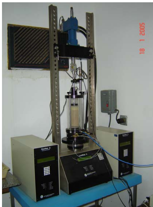
Figura 2.1 – Equipamento triaxial cíclico da UFV.
