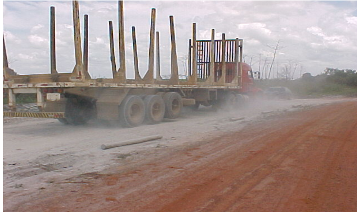
Figura 7.5 - Excesso de poeira com médio nível de severidade
