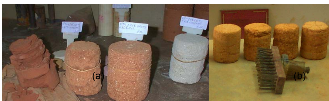
Figura 5.1 - Corpos-de-prova do ensaio de durabilidade por molhagem e secagem (2a) e escova de aço (2b)
