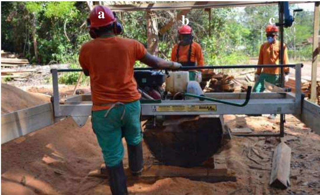
**Figura 4-** Maquinário utilizado e composição da equipe de trabalho. (a -Operador de serraria portátil; b- Auxiliar de serraria portátil; c- Empilhador de madeira serrada).
