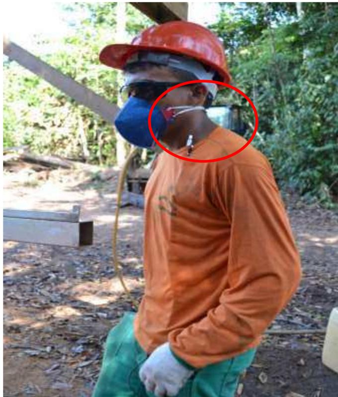
**Figura 8-** Medidor de nível de pressão sonora Dosímetro, o componente microfone foi colocado próximo ao ouvido do trabalhador.
