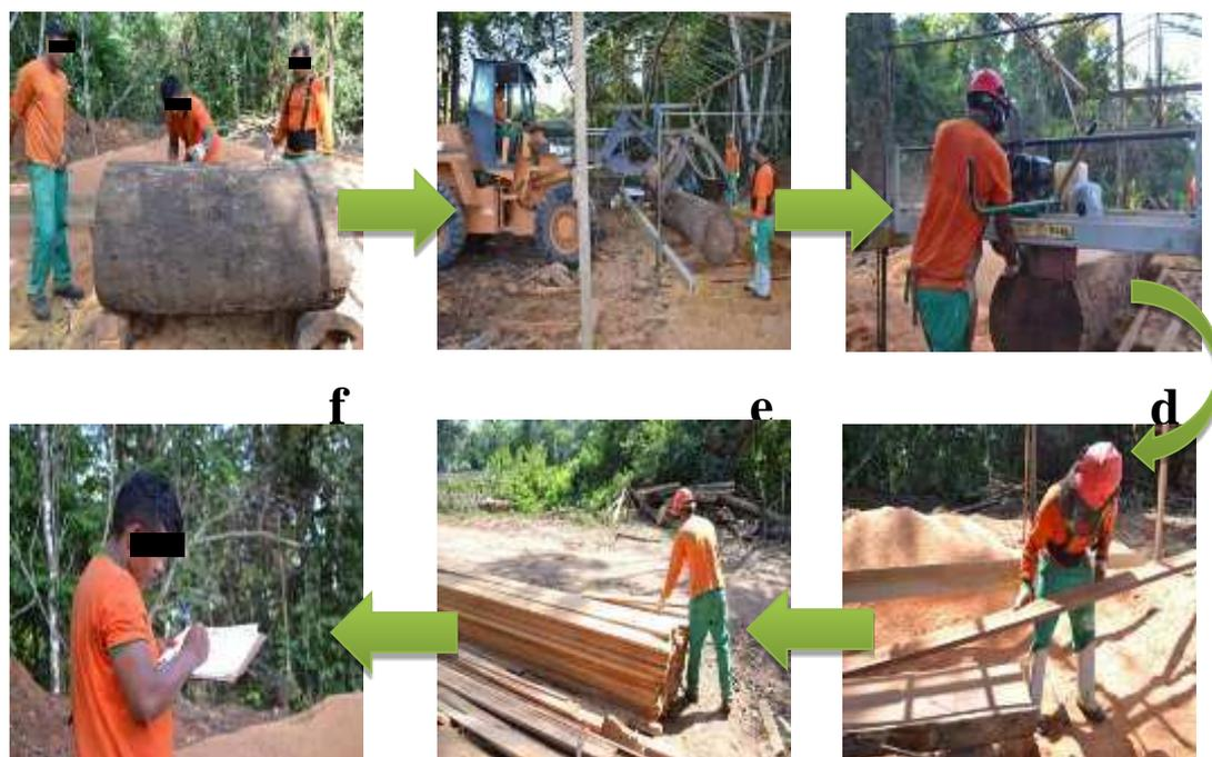
**Figura 3-** Fluxograma das etapas de desdobro de resíduo com serraria portátil. (a - Escolha do resíduo; b - Empilhamento dos toretes com carregadeira para a lateral da serraria portátil; c- Processamento dos toretes; d - Retirada da madeira serrada; e - Empilhamento da madeira serrada; f- Anotação dos dados decampo).
