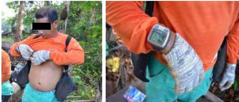
**Figura 6-** Equipamento Garmin fixado no tórax e no pulso do trabalhador.
