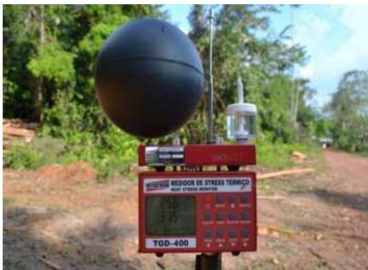
**Figura 7** - Medidor de stress térmico - Índice de Bulbo Úmido Termômetro de Globo- IBUTG.
