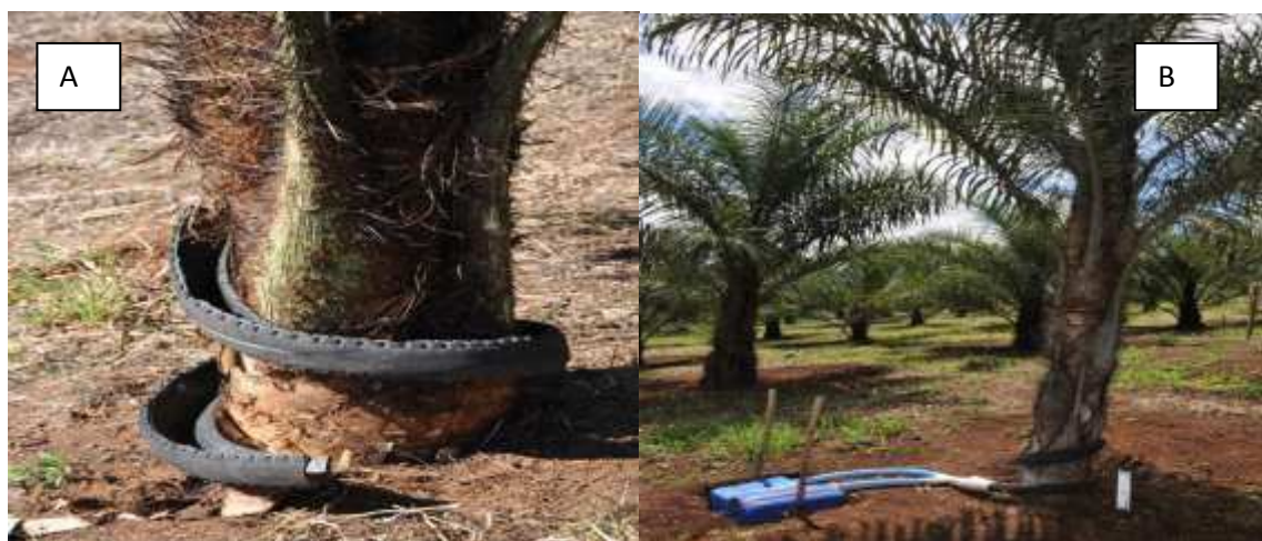
Figura 1: Coletor de água de escoamento sendo montado (A), Coletor com mangueira e galões (B).
