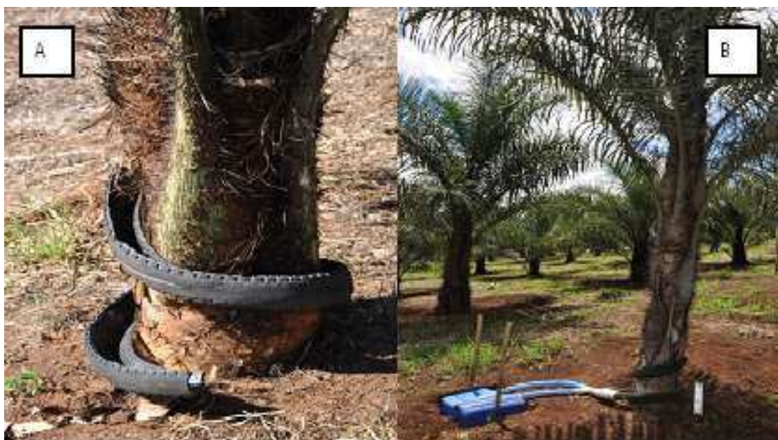
Figura 4: Coletor de água de escoamento sendo montado (A), Coletor com mangueira e galões (B). Fazenda Experimental da UFV, município de Araponga, MG.
