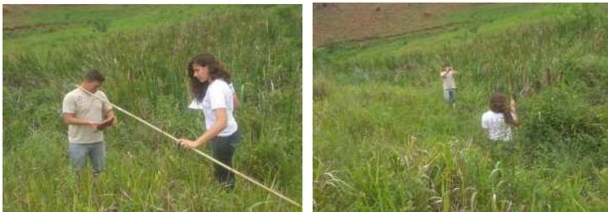
Figura 10: Execução de levantamento topográfico utilizando clinômetro, baliza e trena em nascentes do município de Viçosa. MG, no ano de 2016.
