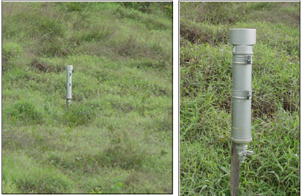
Figura 9 a – Pluviômetro utilizado na medição da precipitação em aberto: (a) pluviômetro simples de PVC, reserva Mata do Paraíso, Viçosa – MG, no período de 2002 - 2005.
