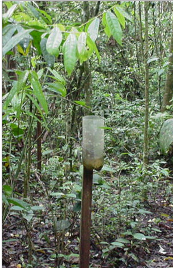
Figura 10 b – Coletor (b) utilizado para quantificar a precipitação interna (PI), reserva Mata do Paraíso, no período de 2002 – 2005, Viçosa - MG.
