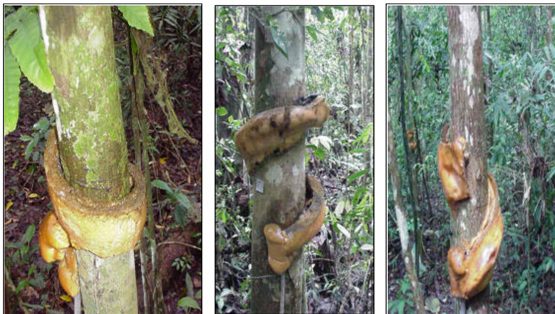
Figura 11 – Coletores utilizados para quantificar o escoamento pelo tronco, reserva Mata do Paraíso, Viçosa – MG, no período de 2002 – 2005.
