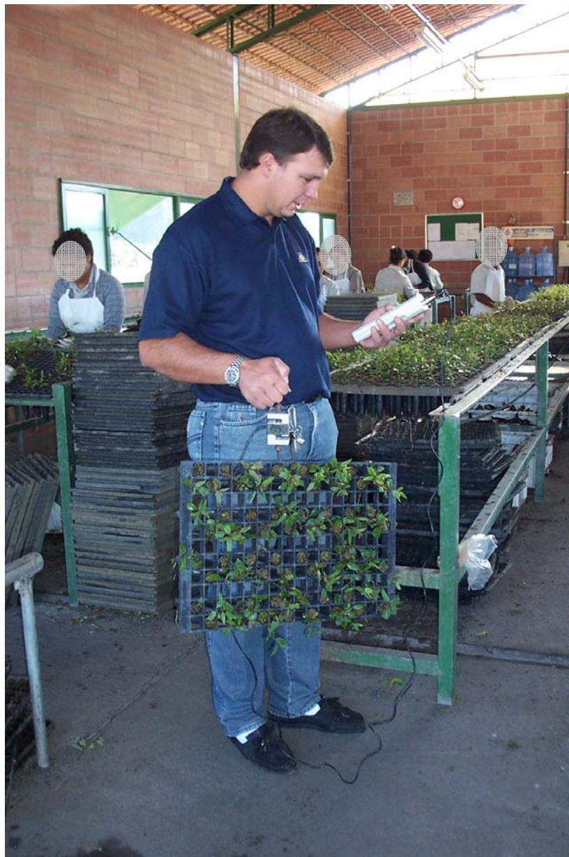
Figura 13 - Medição das forças envolvidas no deslocamento das bandejas.
