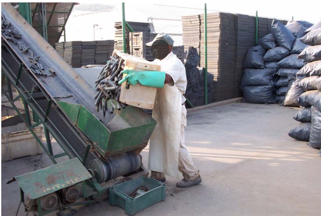
Figura 1 - Lavagem dos tubetes.
