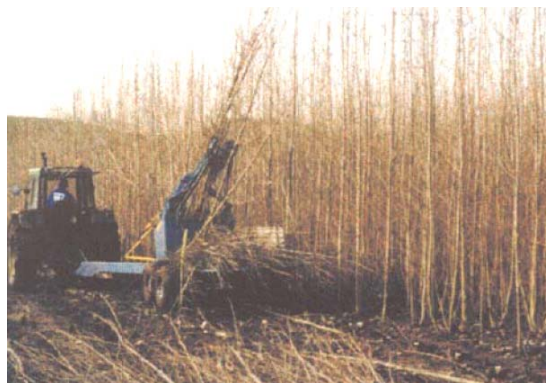
Figura 22. Colhedora de corte contínuo do tipo cut-only ( Frobbesta Coppice Harvester ).
