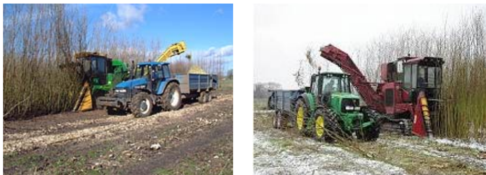
Figura 21. Colhedoras de corte contínuo do tipo cut-and-chip .
