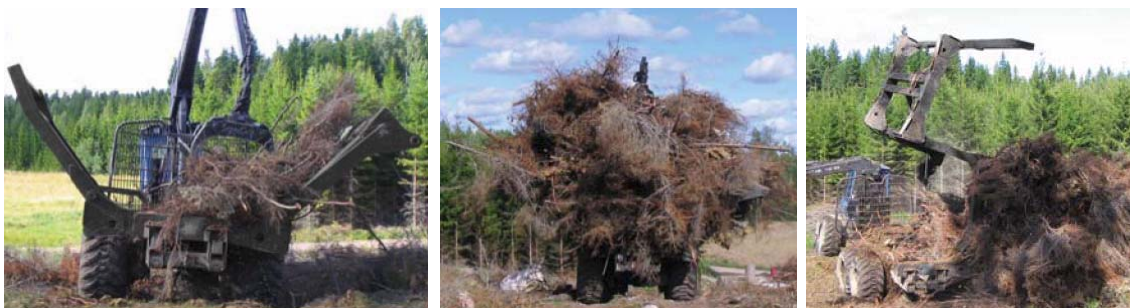
Figura 5. Carregamento (esquerda), transporte (centro) e descarregamento (direita) de resíduos florestais com a caçamba compressora adaptada em Forwarder .
