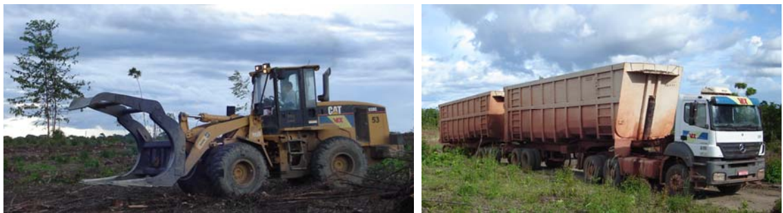
Figura 2. Carregadora hidráulica frontal Caterpillar 938G com pneus (esquerda) e caminhão Mercedes-Benz Axor 3340 com caçambas basculantes (direita).
