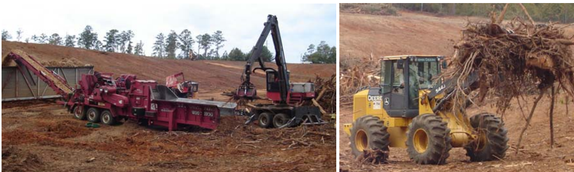
Figura 2. Triturador florestal Morbark 4600XL abastecido por grua hidráulica Prentice 310E (esquerda) e carregadora frontal John Deere 544J (direita).
