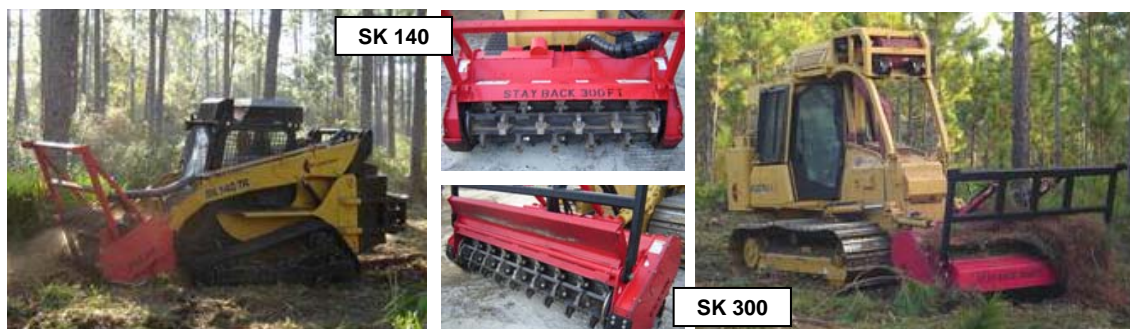
Figura 4. Tratores Supertrak, SK 140 e SK 300, equipados com implemento Fecon.
