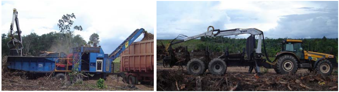
Figura 1. Picador florestal Bruno 196 (esquerda) e trator florestal Valtra BH145 equipado com grua TMO AC9718 (direita).
