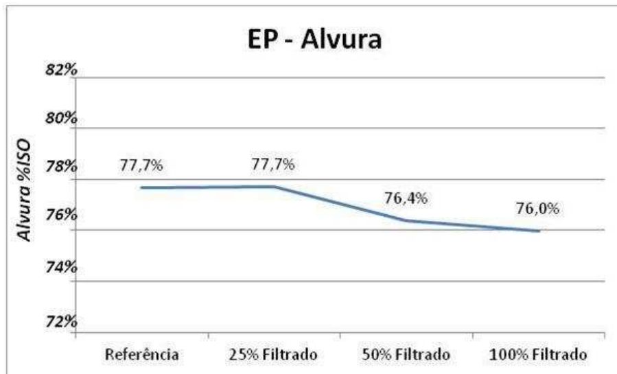
Figura 19: Alvuras alcançadas no estágio EP a diferentes níveis de recirculação do filtrado.
