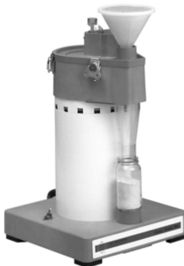
Figura 1: Moinho ciclone utilizado no preparo de amostras.
