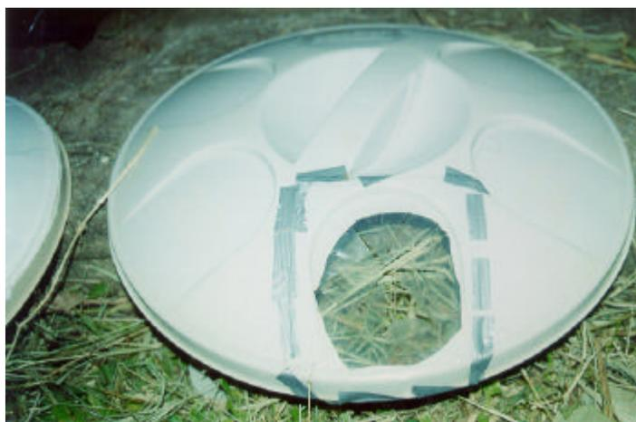
Figura 9 – Orifício aberto na tampa do coletor.
