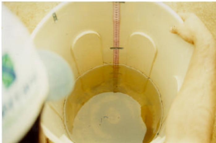
Figura 11 – Processo de medição indireta do volume de água escoado.
