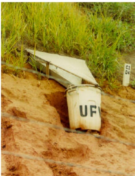
Figura 7 – Sistema coletor do escoamento superficial.
