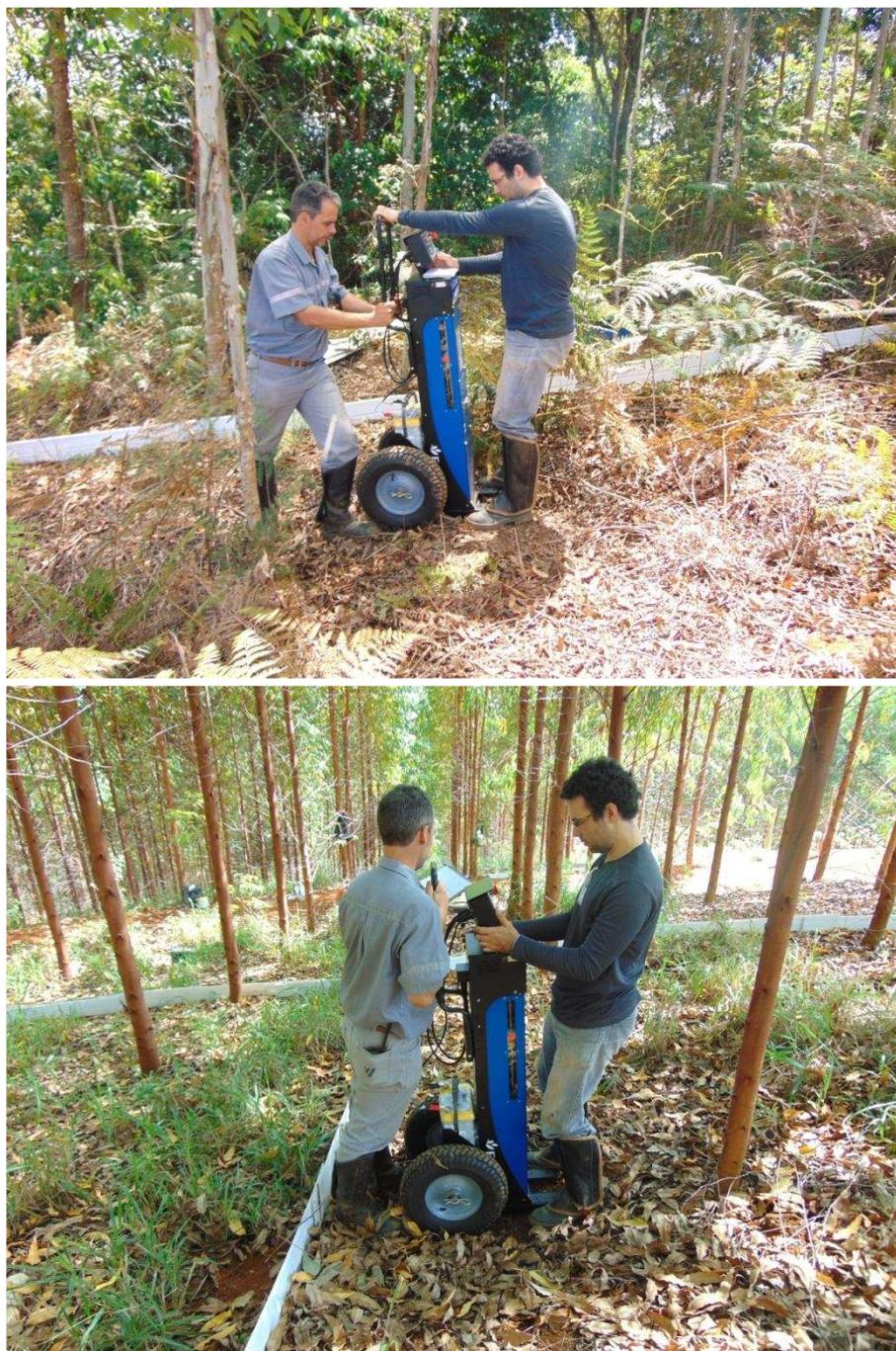
**Figura 11.** Medição da resistência mecânica do solo à penetração com o penetrógrafo automatizado na área pré-lavra (acima) e na área pós-lavra (abaixo), em 23 de março de 2017.
