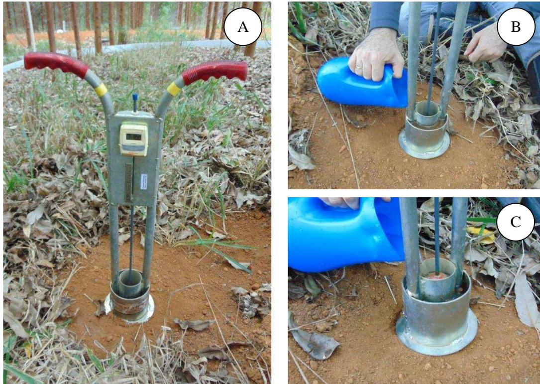
**Figura 10.** Infiltrômetro de anéis concêntricos (A) e ensaio da velocidade e capacidade de infiltração do solo, sendo em B) a colocação de água no cilindro externo até a diminuição da velocidade de infiltração e em C) a colocação de água no cilindro interno e início do ensaio, em 17 de maio de 2017.
