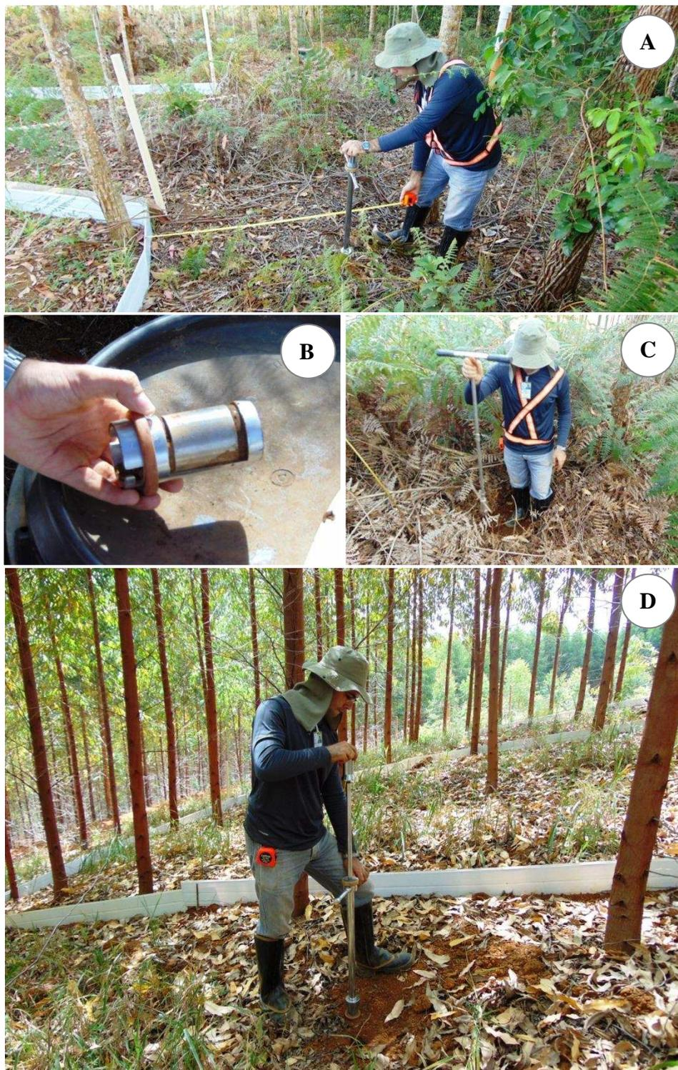
**Figura 12.** Amostragem de solo para análises físicas, em 16 de março de 2017. A) padronização da coleta do solo deformado e indeformado; B) amostra de solo indeformado em anel volumétrico; C) amostra de solo deformado para análise de textura; e D) coleta de solo indeformado com o trado Uhland.
