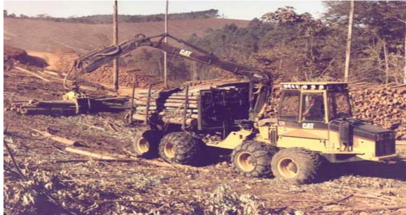
Figura 4 - Operação de extração de toretes com o Forwarder .
