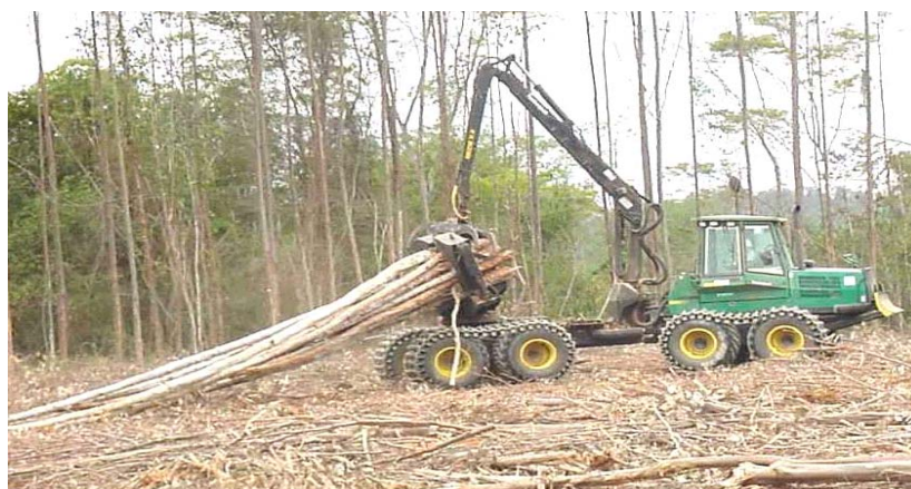
Figura 6 - Operação de extração de toras com o Clambunk Skidder .
