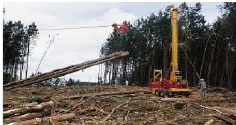
Figura 9 - Operação de extração de toras com o cabo aéreo.
