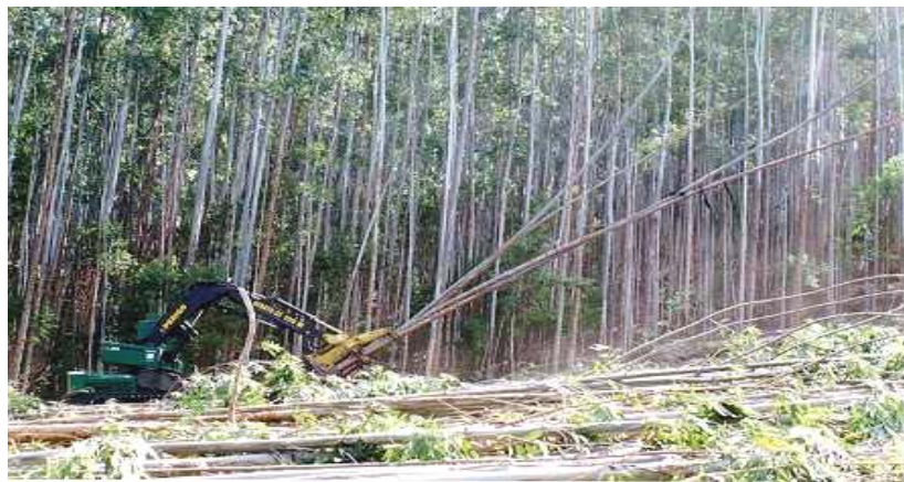
Figura 5 - Operação de corte mecanizado (derrubada) com o Feller Buncher .
