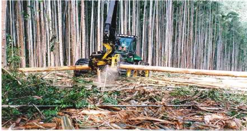
Figura 7- Operação de corte mecanizado com o Harvester .
