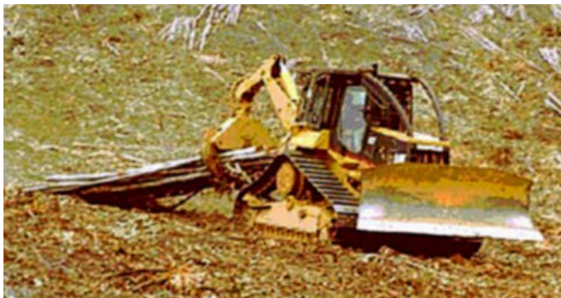
Figura 3 - Operação de extração de toras com o Track Skidder .
