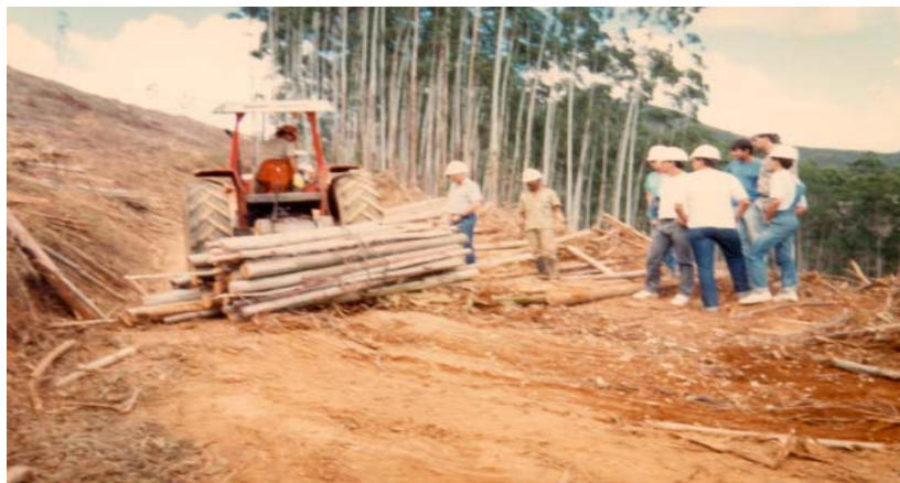
Figura 2 - Operação de extração de toretes com o Guincho TMO.
