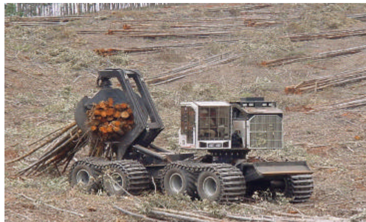
Figura 6 - Operação de extração das toras com o Timbco Skidder no subsistema 4.
