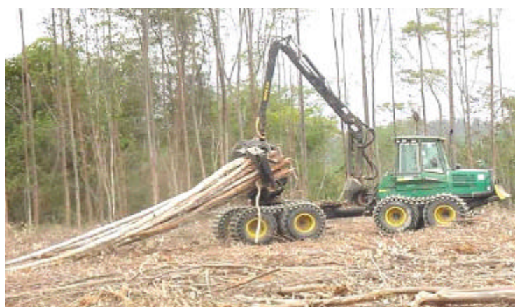
Figura 7 - Operação de extração das toras com o Clambunk Skidder no subsistema 5.
