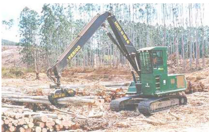
Figura 9 - Operação de traçadora das toras com a Garra Traçadora nos subsistemas 4, 5 e 6.
