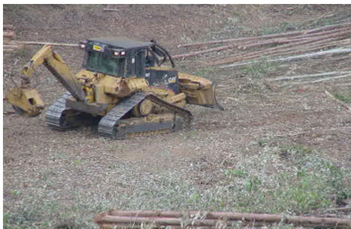
Figura 8 - Operação de extração das toras com o Track Skidder no subsistema 6.
