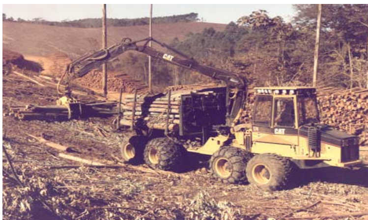
Figura 4 - Operação de extração dos toretes com o Forwarder no subsistema 3.
