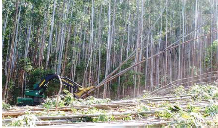
Figura 5 - Operação de corte mecanizado com o Feller Buncher nos subsistemas 4, 5 e 6.
