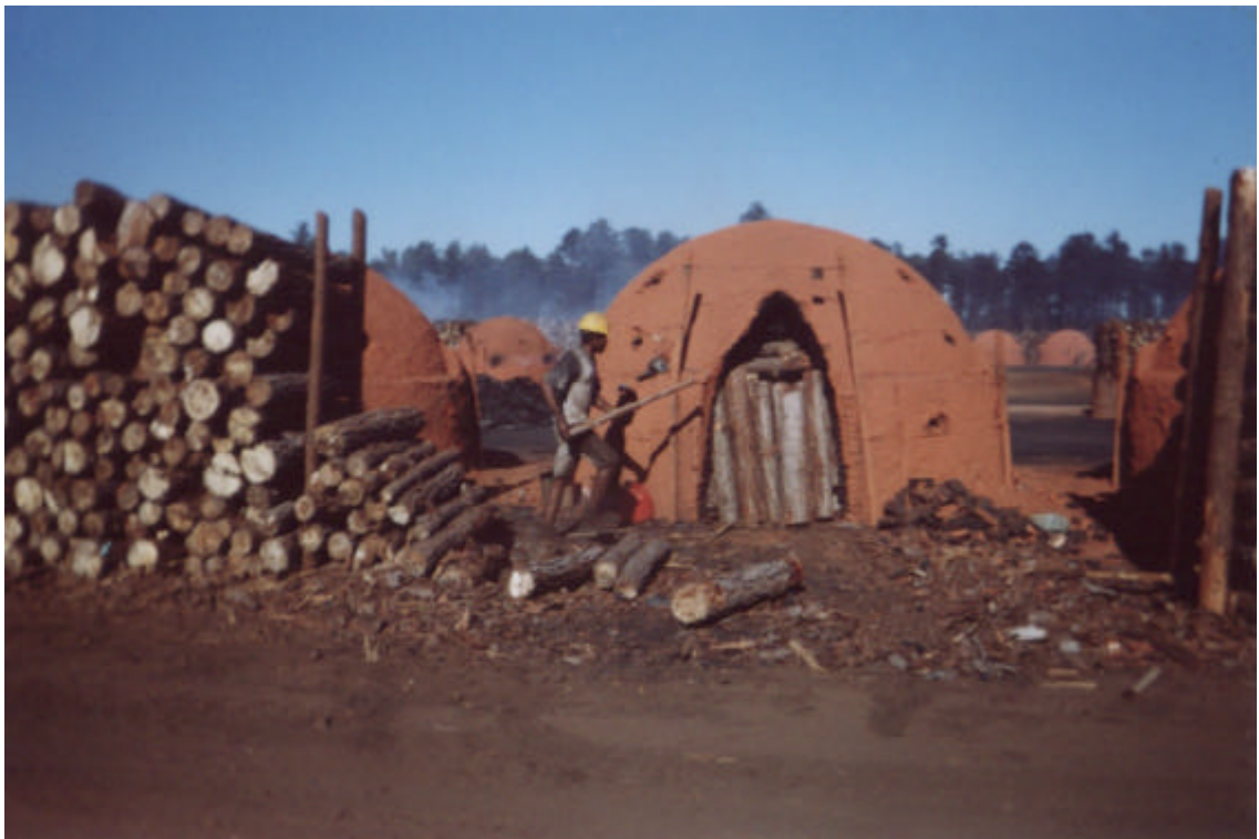
Figura 5 - Foto referente à operação de carga. Término do enchimento do forno.
