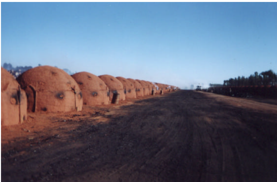
Figura 9 - Foto referente aos fornos passando pelo período de resfriamento.
