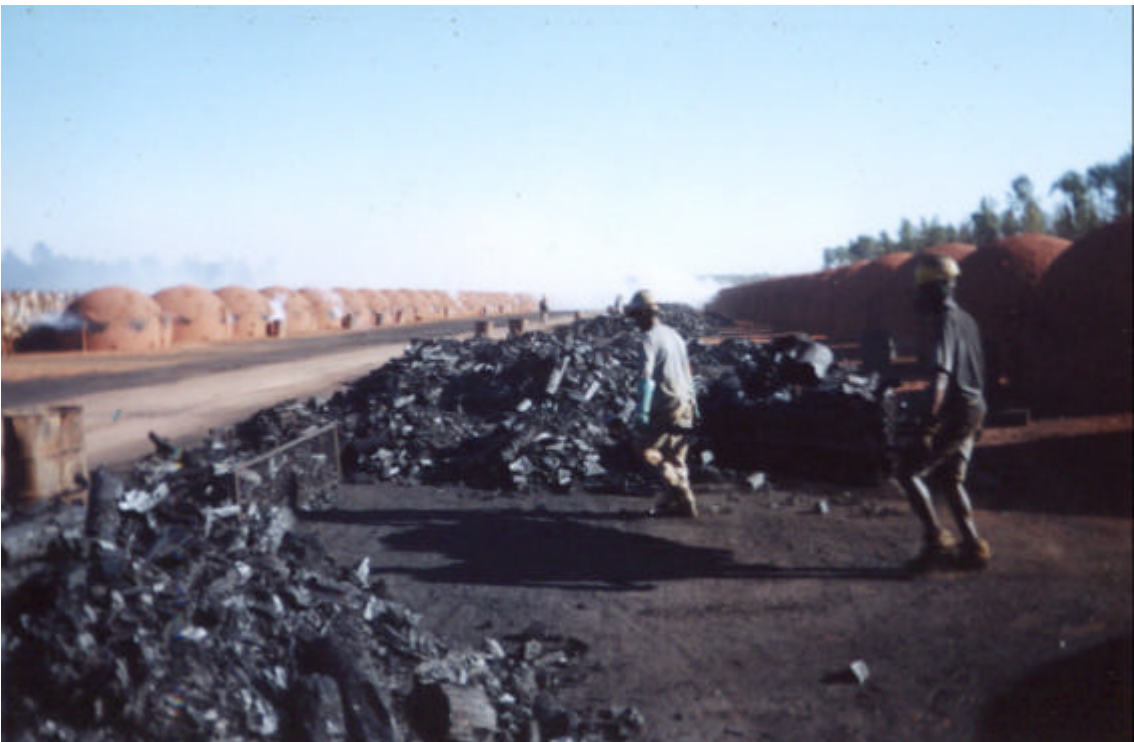
Figura 2 - Foto referente à operação de descarga. Transporte do carvão até o pátio.
