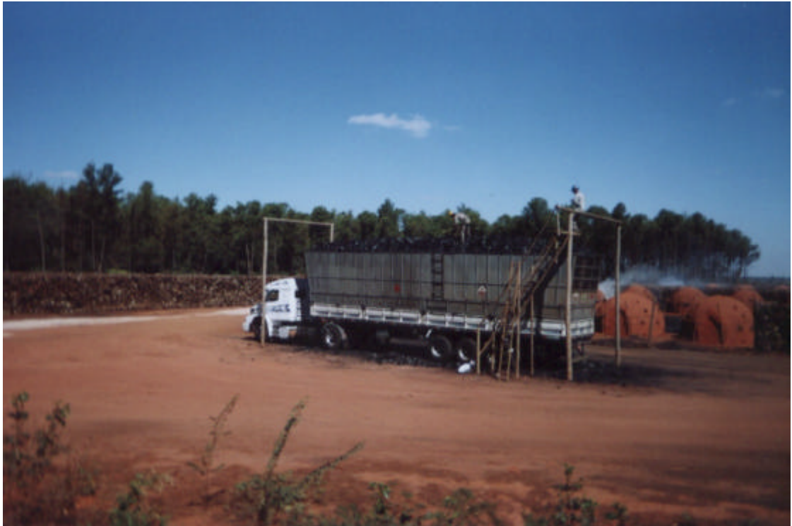
Figura 10 - Foto referente à operação de expedição. O carvão estava sendo medido pelo operário para ser enviado à fábrica.
