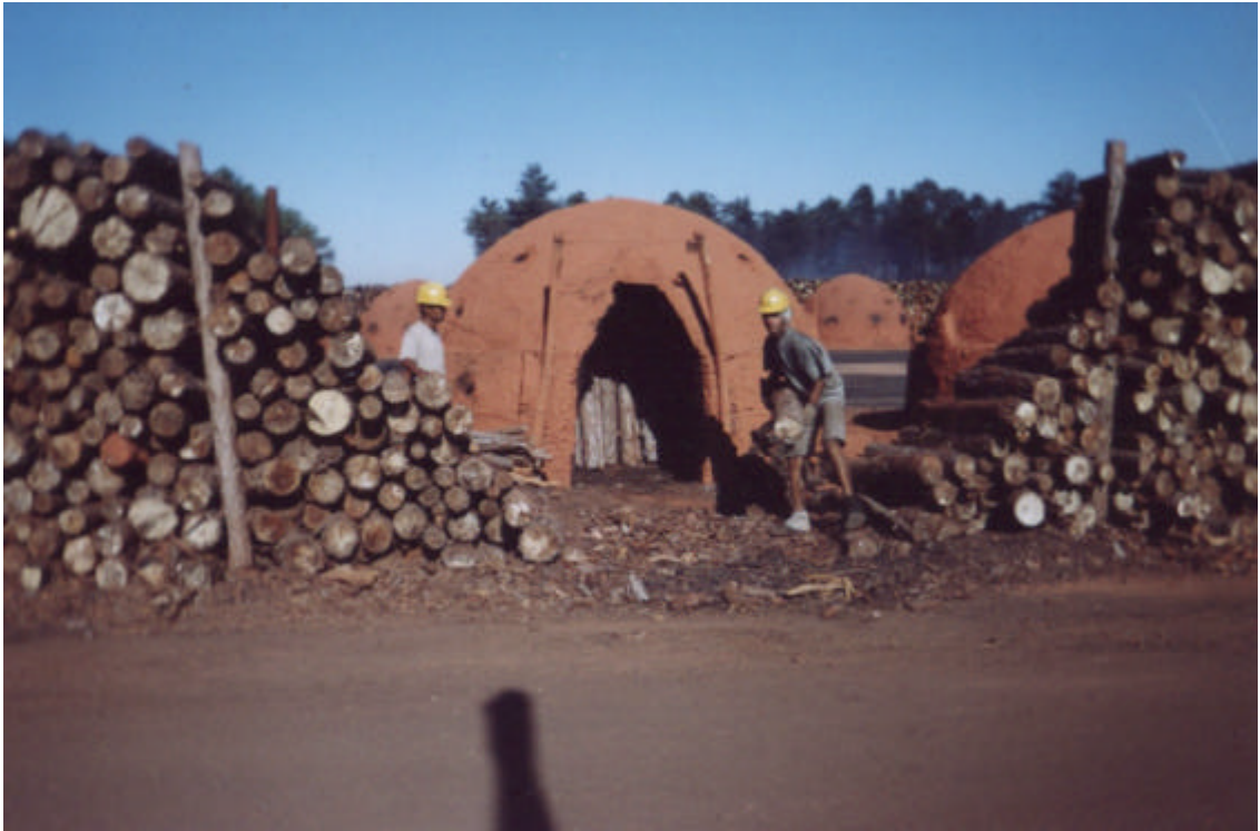
Figura 4 - Foto referente à operação de carga. Enchimento do forno.
