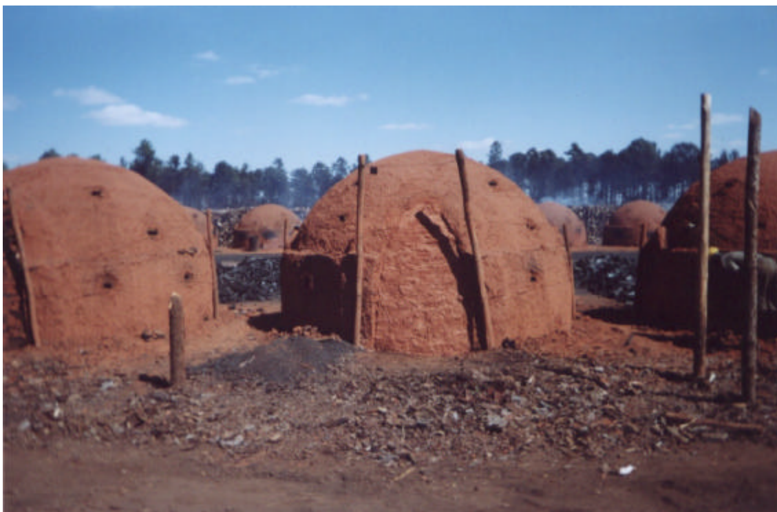
Figura 6 - Foto referente à operação de carga. Forno completamente cheio e fechado.
