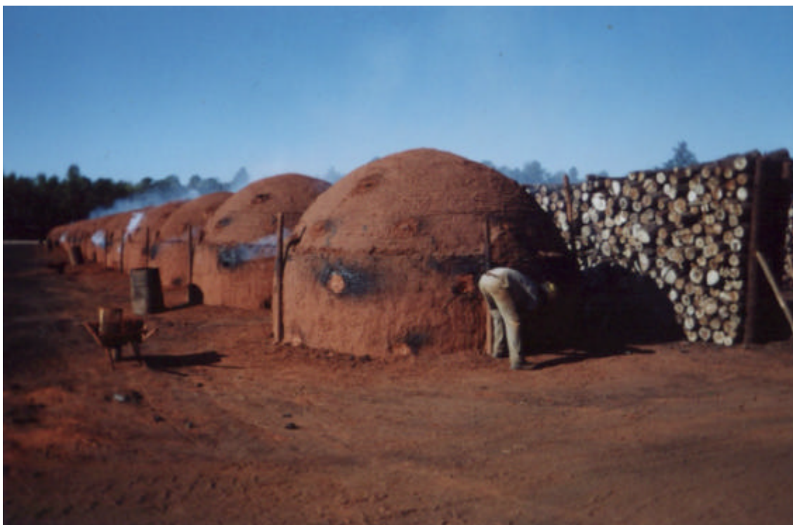
Figura 8 - Foto referente à operação de vedação.
