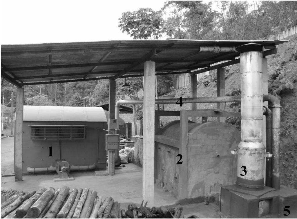
**Figura 3** - Vista geral do sistema forno-fornalha e do sistema de secagem, sendo: 1) Secador; 2) forno; 3) fornalha; 4) rede de transporte de gases; 5) misturador.
