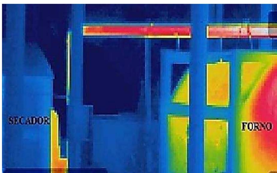
**Figura 12** – Imagem termográfica no infravermelho do forno e tubulação de transporte de gases.
