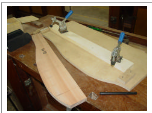
Figuras 6 e 7 – Molde curvo e realização da fresagem na tupa de mesa.
