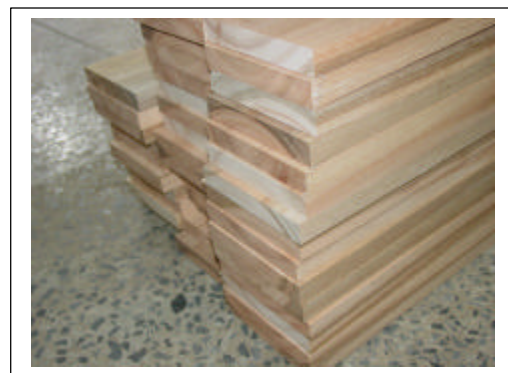
Figuras 4 e 5 – Amostras cortadas no sentido transversal às fibras.
