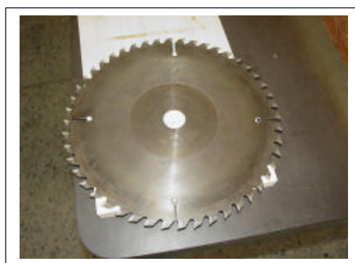
Figuras 2 e 3 – Serra circular de carrinho e serra circular de 48 dentes.
