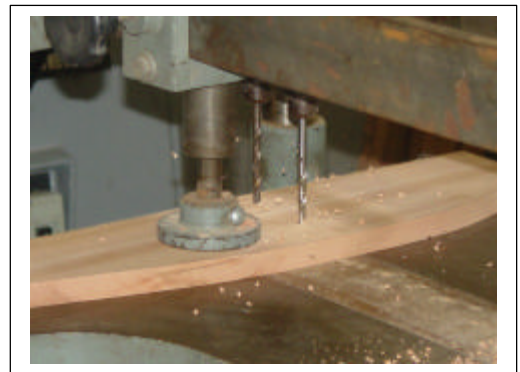
Figuras 10 e 11 – Broca chata e furação com as brocas helicoidais.
