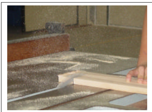
Figuras 4 e 5 – Amostras cortadas no sentido transversal às fibras.
