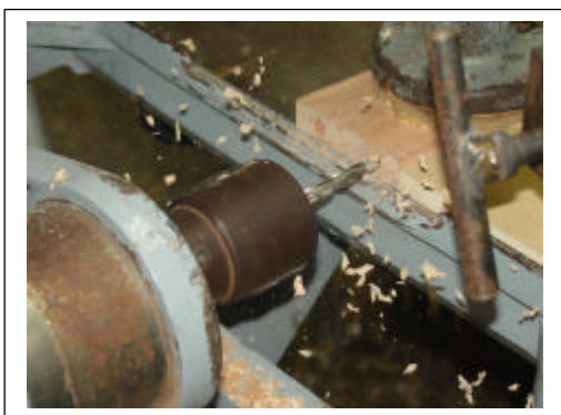
Figuras 14 e 15 – Furação para cavilha e peças usinadas.
