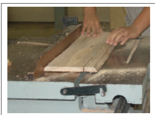
Figuras 2 e 3 – Serra circular de carrinho e serra circular de 48 dentes.
