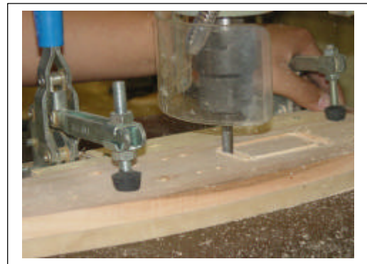
Figuras 16 e 17 – Confeção do gabarito e realização do teste de moldura.
