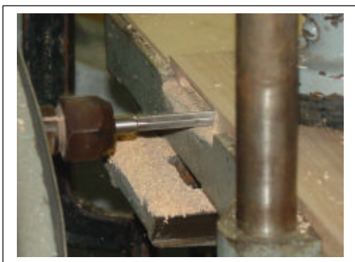
Figuras 12 e 13 – Furação para espiga e peças usinadas.
