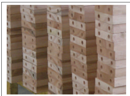
Figuras 14 e 15 – Furação para cavilha e peças usinadas.
