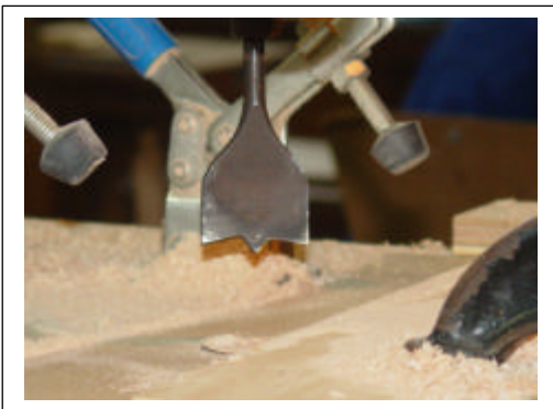
Figuras 10 e 11 – Broca chata e furação com as brocas helicoidais.
