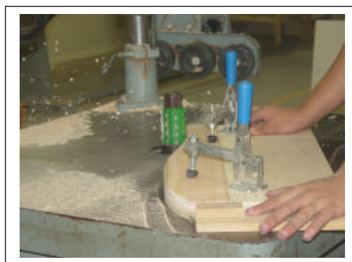
Figuras 6 e 7 – Molde curvo e realização da fresagem na tupa de mesa.
