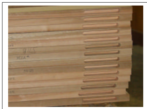
Figuras 12 e 13 – Furação para espiga e peças usinadas.
