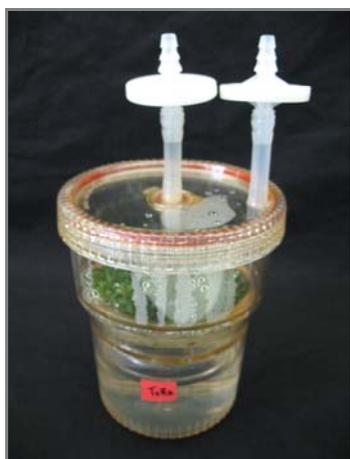
Figura 2 – Modelo do recipiente de imersão temporária automatizada – RITA<sup>®</sup>, utilizado nesta experimentação.
