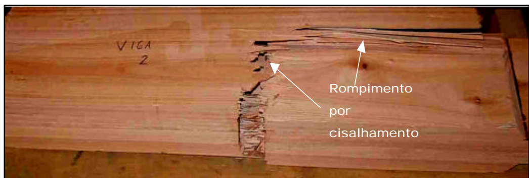
Imagem 3E- Ruptura da viga 2 com cobrejunta de 4 metros de vão.
