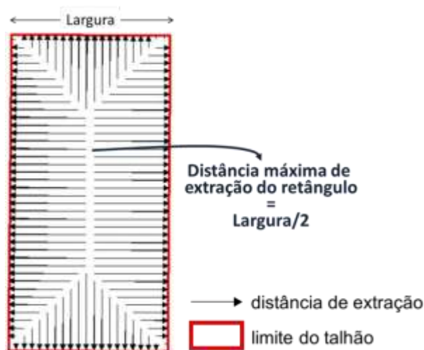
Figura 1. Representação de um talhão retangular e os trajetos de extração com a menor distância até sua margem.
