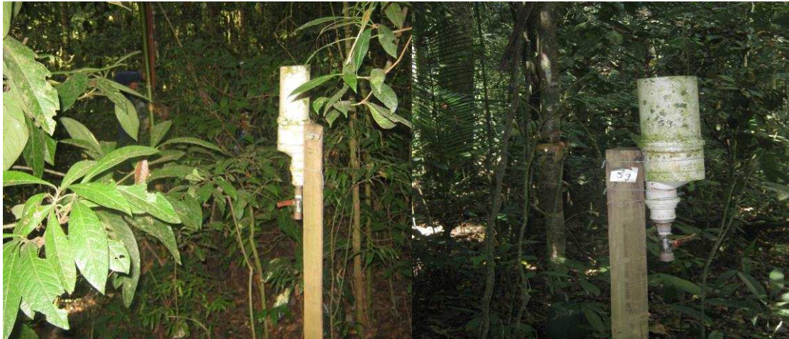
Figura 5 - Imagens de pluviômetros de coleta de precipitação interna na Mata do Paraíso em Viçosa – MG.
