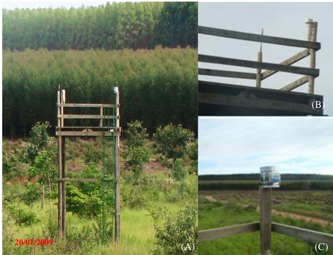
Figura 8 - Minitorre (A) onde estão instalados um pluviômetro, evapotranspirômetro (B) e um pluviógrafo (C). Felixlândia - MG, 2009.
