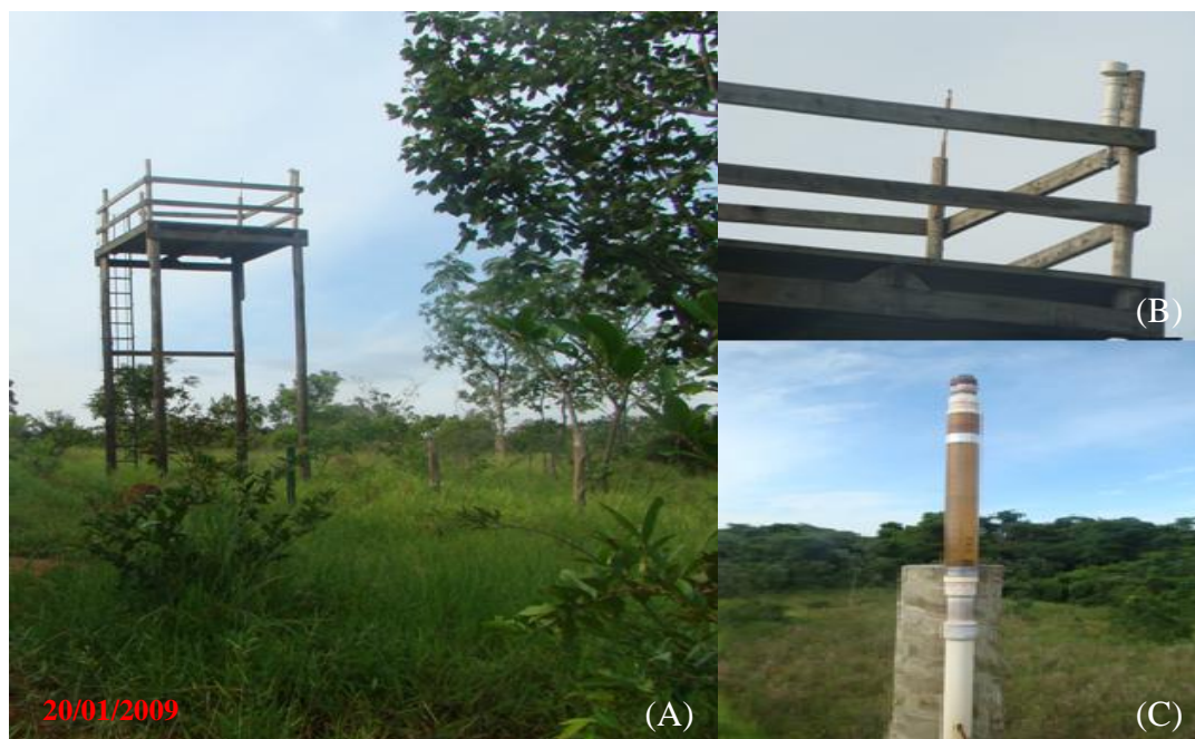
Figura 7 - Minitorre (A) localizada próxima ao vertedouro onde estão instalados o pluviômetro (B) e o evapotranspirômetro (C), Felixlândia - MG, 2009.
